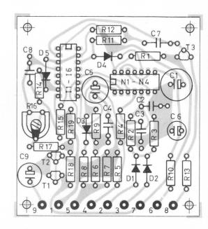
Alle Eingänge der Schaltung sind mit einer Schutzbeschaltung versehen. Den Eingängen "Standlicht" und "Zündung" sind RC-Glieder mit längeren Zeitkonstanten vorgeschaltet. Die hierdurch erreichten Verzögerungen sollen das Warnsignal beim Anlassen mit eingeschaltetem Standlicht und beim Einschalten des Standlichtes während der Fahrt für kurze Zeit unterdrücken.
