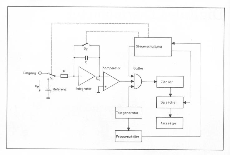
Durch geeignete Wahl der Referenzspannung und der Taktfrequenz wird eine Zuordnung wie etwa 1V = 1000 Impulse erreicht.
