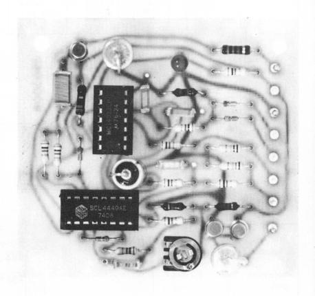
Mit dieser Schaltung wird die korrekte Beleuchtung eines Kraftfahrzeuges überwacht. Beim Parken mit Abblendlicht und Fahren mit Standlicht wird von der Überwachungsschaltung ein optisches und akustisches Warnsignal abgegeben.
