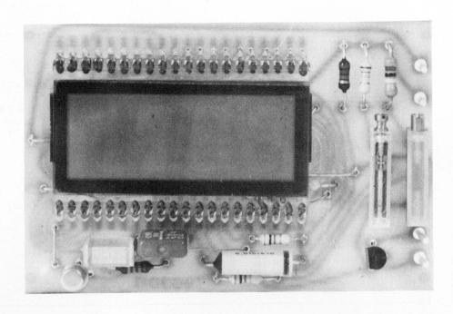
Das Präzisionsthermometer ist zum Messen von Innen- und Außentemperaturen geeignet und hat eine Auflösung von 0,1 Grad. Als Fühler dient ein Siliziumtransistor in Diodenschaltung.
