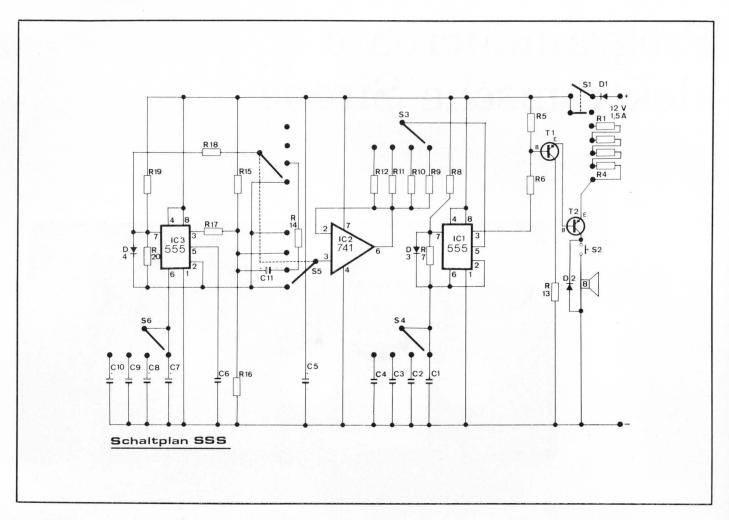
Der Ausgang steuert über den Leistungsverstärker mit den Transistoren T1 und T2 den Lautsprecher an.
