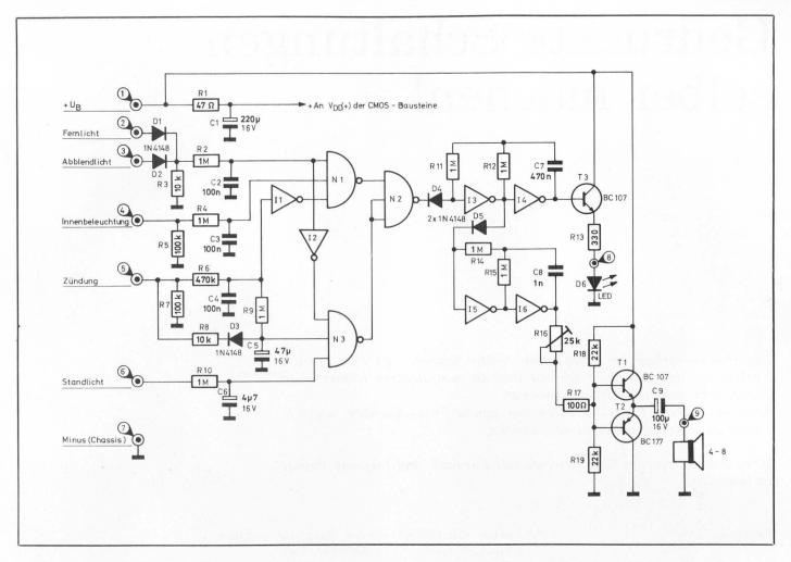
eine Oder-Schaltung für Fernlicht oder Abblendlicht aufgebaut. Der Eingang "Zündung" wird mit dem Inverter I1 invertiert am Nand N1 angeschlossen.
