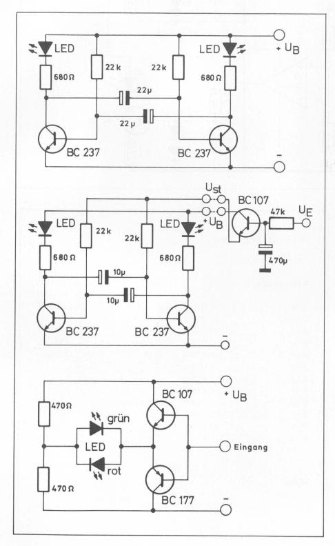
In diesem Beitrag sollen einige Beispiele für den Einsatz von Leuchtdioden in Multivibratoren gezeigt werden. Die Funktionsweise eines Multivibrators wurde im Heft 1 unseres Magazins ausführlich erklärt.
