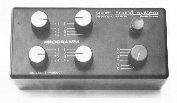
Mit dieser Sirene können verschiedene Sirenengeräusche erzeugt werden. Die Programmierung erfolgt über vier Stufenschalter und ist somit sehr leicht zu verändern. Die Schaltung ermöglicht u.a. die Simulation des bundesdeutschen Martinshorns, der Kojak-Sirene und der Hawaii 5-0-Sirene. Insgesamt sind 256 verschiedene Geräusche möglich.
