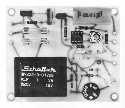
Nach dieser Schaltung kann ein einfacher und preiswerter Zeitschalter aufgebaut werden. Die einstellbare Zeit liegt im Bereich von 0,5-200 Sekunden. Der Timer eignet sich somit insbesondere zum Belichten von fotografischen Materialien.
