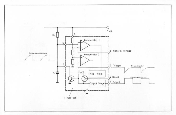
Schaltwelle der Komparatoren extern beeinflußt werden. Wird das Potential an Pin 5 angehoben, so schalten die Komparatoren erst bei höherer Kondensatorspannung um. Die mit Ra und C eingestellte Zeit wird also verlängert.
