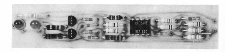
Der einfache Logiktester ist gleichermaßen in TTL- und CMOS-Schaltungen einsetzbar. Die Schaltung eignet sich aber auch als Spannungsprüfer in Analogschaltungen.
