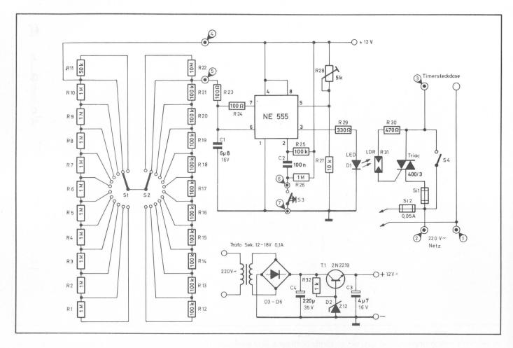
Die Betriebsspannung des Timers wird durch den Transistor T1 mit der Z-Diode D2 als Referenz auf etwa 12 V stabilisiert.
