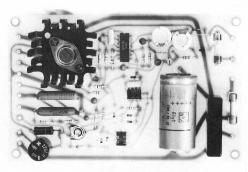
vorganges mit vollen 2 A geladen wird. Erst nachdem der Akku nahezu voll aufgeladen wurde und die Spannung 14 V erreicht hat, beginnt der Strom langsam zu sinken und sich auf Werte einzupegeln, die lediglich zu einer Erhaltungsladung führen, d.h. der Akku wird nur mit einem Strom gespeist, der ihn den aufgeladenen Zustand beibehalten läßt.
