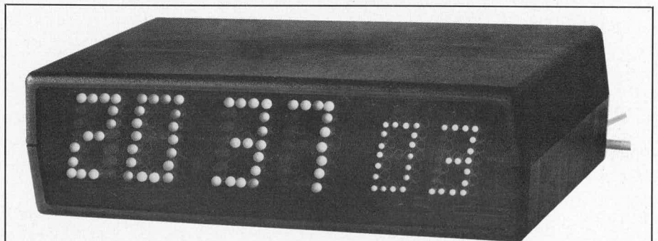
Ansicht der ELV-Goliath-Uhr: Man beachte die völlig geschlossene Frontplatte (rote Plexiglasscheibe), die jetzt ohne äußere Schalter ist.
