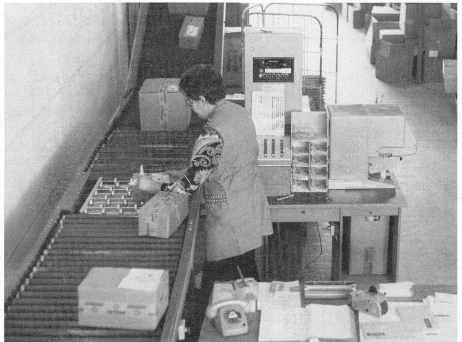
*Im Laufband integrierter automatischer Wiege- und Portocomputer*
