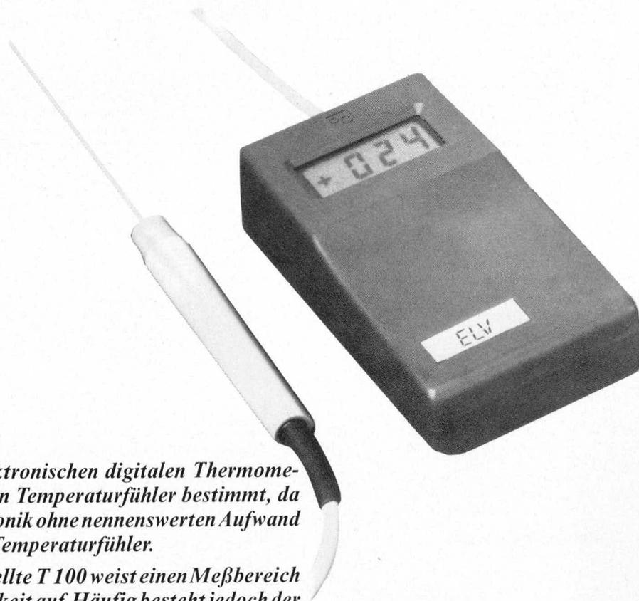
*Einsatzbereich und Qualität von elektronischen digitalen Thermometern werden im wesentlichen durch den Temperaturfühler bestimmt, da die zur Auswertung eingesetzte Elektronik ohne nennenswerten Aufwand erheblich besser ist als die meisten Temperaturfühler.*
