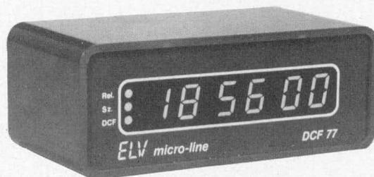
*Die doc 85 ist ein komplettes Uhrensystem, das seine Zeitinformation von dem PTB-Sender DCF 77 in Mainflingen bei Frankfurt erhält. Die amtliche Uhrzeit für die Bundesrepublik Deutschland wird von diesem Sender mit einer maximalen Abweichung von einer Sekunde in 300 000 Jahren (!) ausgestrahlt. Die Uhr braucht daher niemals gestellt zu werden, da sie ständig, ähnlich einem Rundfunk-Empfänger, die Uhrzeit empfängt.*
