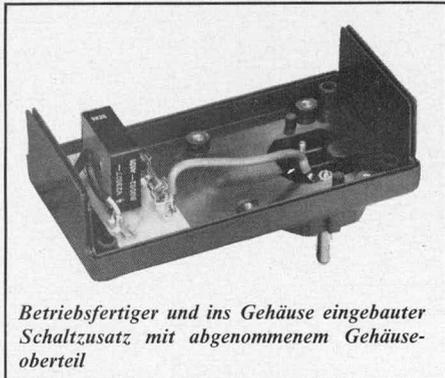
Betriebsfertiger und ins Gehäuse eingebauter Schaltzusatz mit abgenommenem Gehäuse-oberteil
