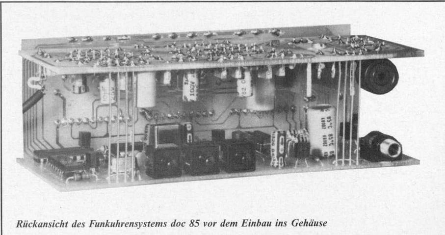
Rückansicht des Funkuhrensystems doc 85 vor dem Einbau ins Gehäuse
