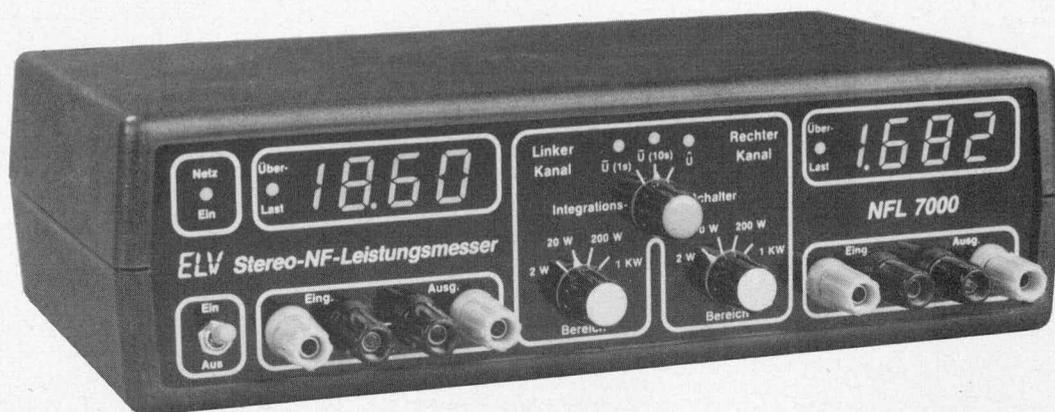
*Mit dem NFL 7000 kann die von einem Verstärker abgegebene und von der Lautsprecherbox aufgenommene NF-Leistung gemessen werden. Durch den Einsatz schneller und breitbandiger Analog-Multiplizierer ist eine echte, vollkommen frequenz- und kurvenformunabhängige Leistungsmessung über 6 Dekaden (!) möglich.*
