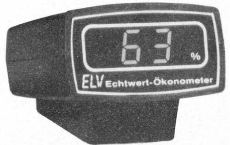
**Mit diesem Echtwert-Ökonomet wird im gesamten Betriebsbereich die Motorauslastung zwischen 0 und 100 % digital angezeigt.**
