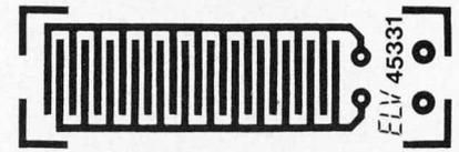
Bild 1: Leiterbahnseite der Sensorplatine für Wasserstopp
