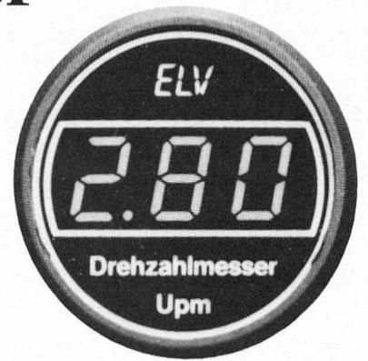
*Dieser 3stellige, digitale Kfz-Drehzahlmesser zeichnet sich durch hohe Auflösung (10 Upm), schnelle Meßfolge (3 Messungen pro Sekunde) sowie gute Genauigkeit (ca. 1 %) und Stabilität aus. Er ist für 3-, 4-, 5-, 6- und 8-Zylinder-Motoren bis zu einer Drehzahl von 10 000 Upm geeignet.*
