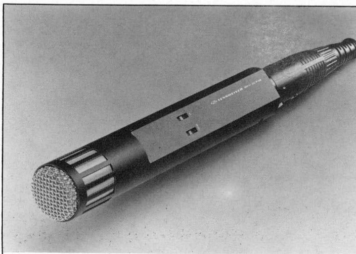
Bild 5.6: Extrem rauscharmes und hocheinstellbares Studio-Kondensator-Mikrofon MKH 40 P48 mit schaltbarem Roll-off-Filter und 10 dB-Abschwächer (Werkfoto: Sennheiser electronic). Das MKH 40 ist ein Gradientenmikrofon mit Nieren-Richtdiagramm
