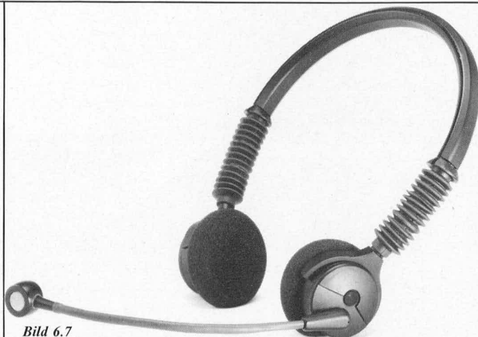
Bild 6.7 Hör-/Sprechgarnitur mit offenen Hörsystemen und beidseitig angeordneten Kompensationsmikrofonen für eine aktive Lärmkompensation (Werkfoto: Sennheiser electronic)
