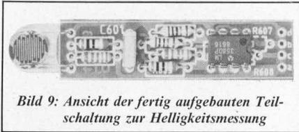
Bild 9: Ansicht der fertig aufgebauten Teilschaltung zur Helligkeitsmessung
