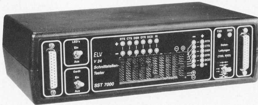
Der ELV-Schnittstellentester SST 7000 ist sowohl zum einfachen und problemlosen Test von V 24/RS 232 C-Schnittstellen geeignet, als auch zur Verbindung zweier entsprechender Schnittstellen untereinander konzipiert. Die Anzeige der logischen Zustände erfolgt hierbei über insgesamt 26 Leuchtdioden. Folgende Testmöglichkeiten stehen zur Verfügung.
