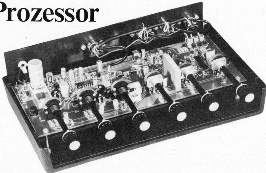
*Der hier vorgestellte Video-Color-Prozessor dient zur nachträglichen Korrektur von Helligkeit, Farbsättigung, Kontrast sowie zur vollkommen unabhängigen Einstellung aller 3 Farbsignalanteile.*
