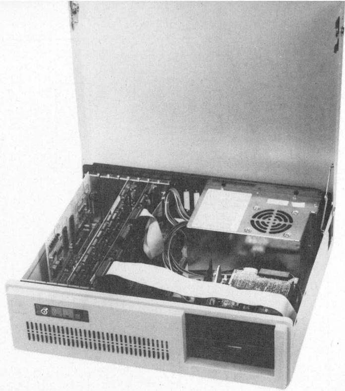
**Der ELV-IC-Tester ermöglicht den logischen Funktionstest fast aller CMOS- und TTL-Standard-Bauteile, die in einem bis zu 20poligen DIL-Gehäuse untergebracht sind. Der IC-Tester ist als Einsteckkarte für den IBM-PC-XT/AT und Kompatible konzipiert. Außerdem wird in diesem Artikel das Serviceprogramm vorgestellt, um die über 500 in Frage kommenden Standardbauteile überprüfen zu können.**
