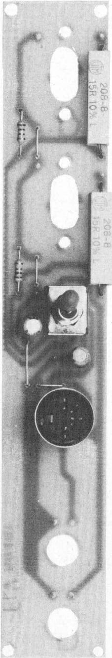
oben: Ansicht der fertig bestückten Basisplatte des High-End-Electrostar-Kopfhörer-Verstärkers (Originalgröße: 430 mm x 240 mm)
