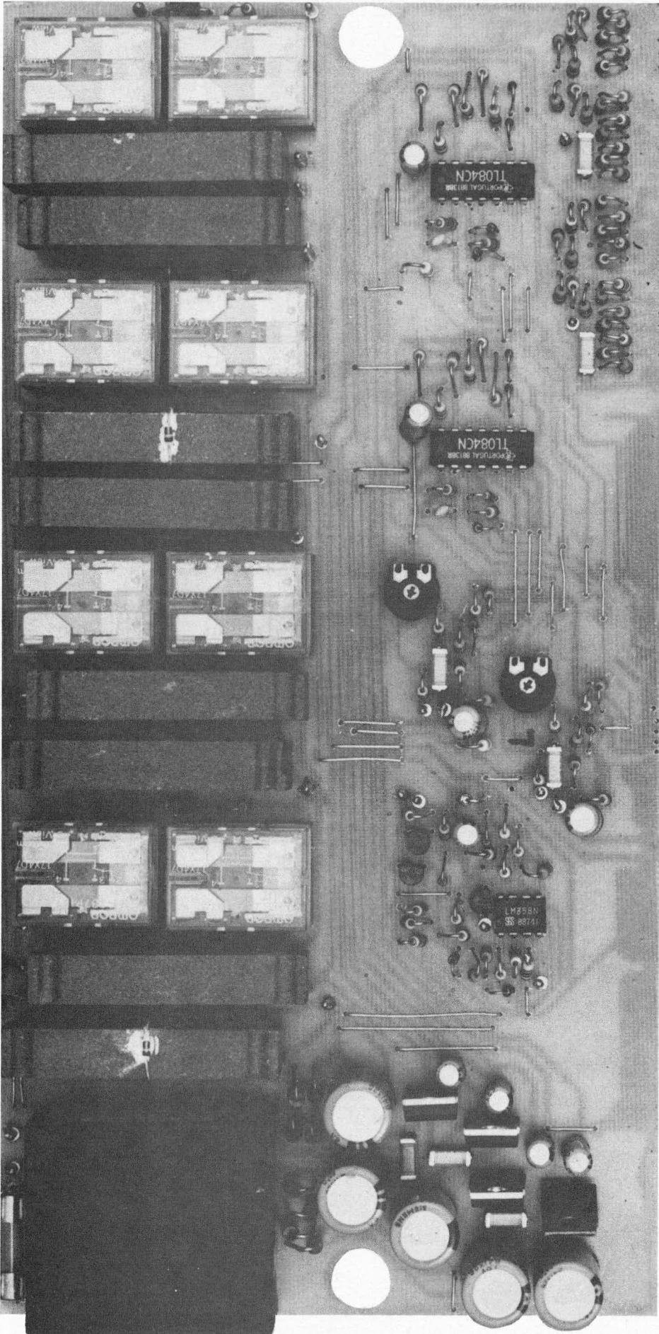
Ansicht der fertig aufgebauten Basisplatine des Stereo-Analog-Wattmeters SW 7000
