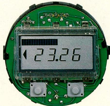
**Ansicht der fertig bestückten Platine des FC 60 von der Display-Seite (Lötseite) aus gesehen**
