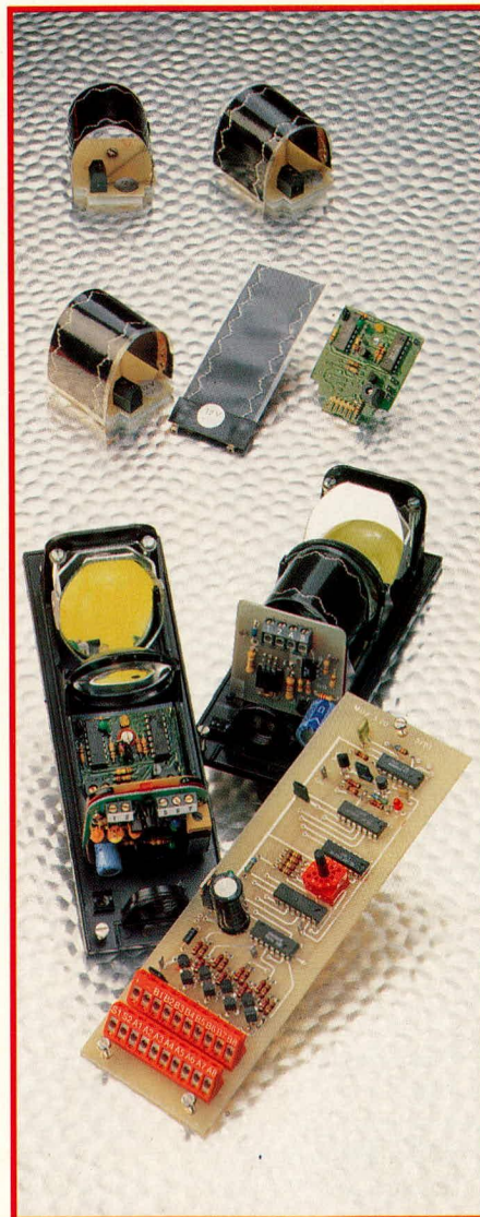
Bild 17: Komponenten hochwertiger IR-Lichtschranken, jeweils ohne Gehäuse. Die Sendeleuchte bzw. Empfangsdiode ist im Spiegel riesenhaft vergrößert zu erkennen. Im Hintergrund Linsenheizungen (Folie mit Widerstandsbahn) sowie ein Modul zur Desaktivierung bei aufkommendem Nebel. Im Vordergrund eine Multiplex-Platine.
