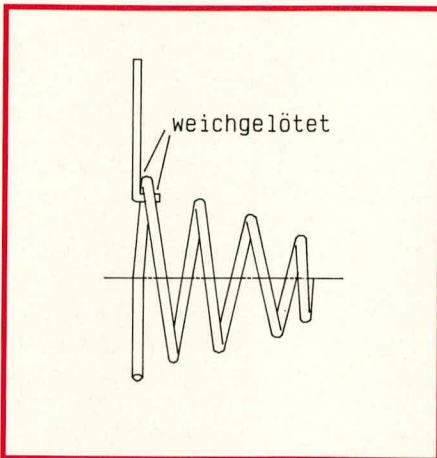
Bild 7: Skizze der Spiralfeder mit angelötetem Anschlußplättchen
