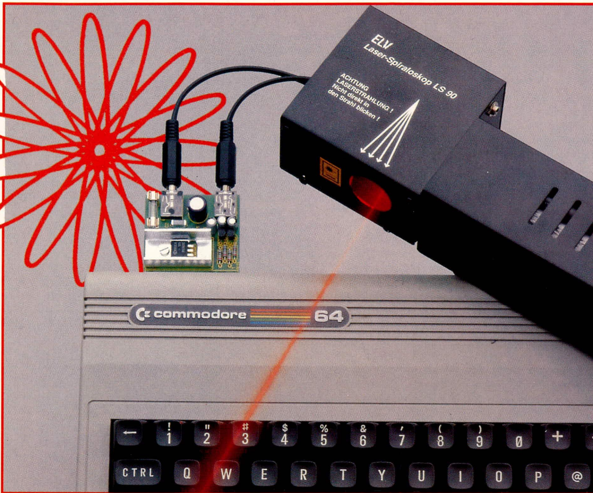
C 64-Computer mit angesteckter Interface-Platine. Darüber ist das Laser-Spiraloskop LS 90 mit dem angeflanschten ELV-12-V-Laser zu sehen.
