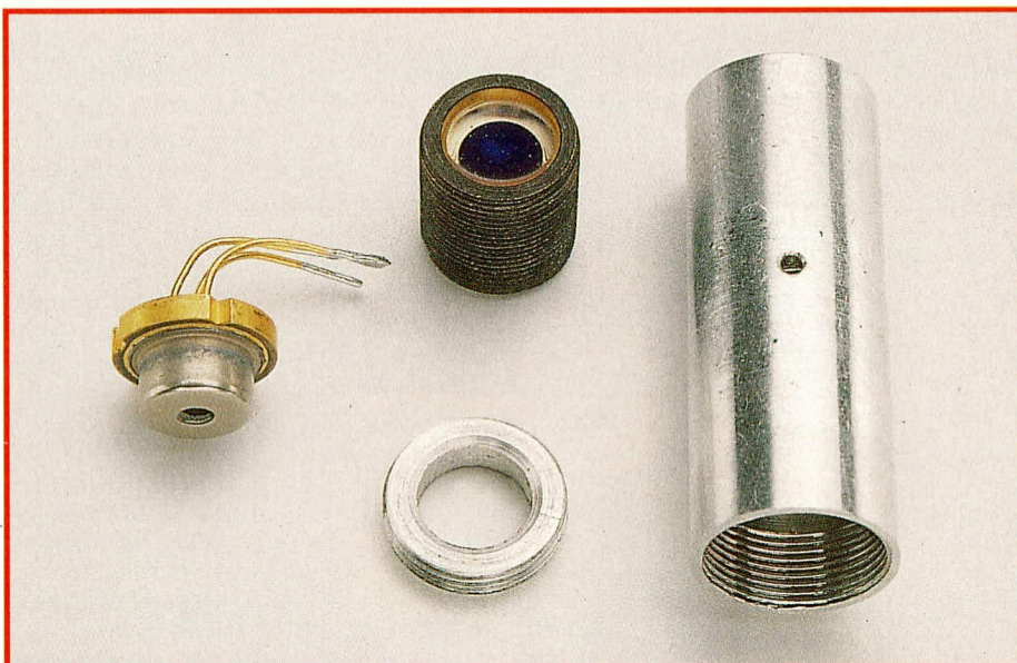
Bild 5: Komponenten zur Laserstrahlerzeugung und -Bündelung: links: Laserdiode, mitte-oben: Bündelungsoptik, mitte-unten: Befestigungsmutter für Laserdiode, ganz rechts: Komponenten-Trägerrohr
