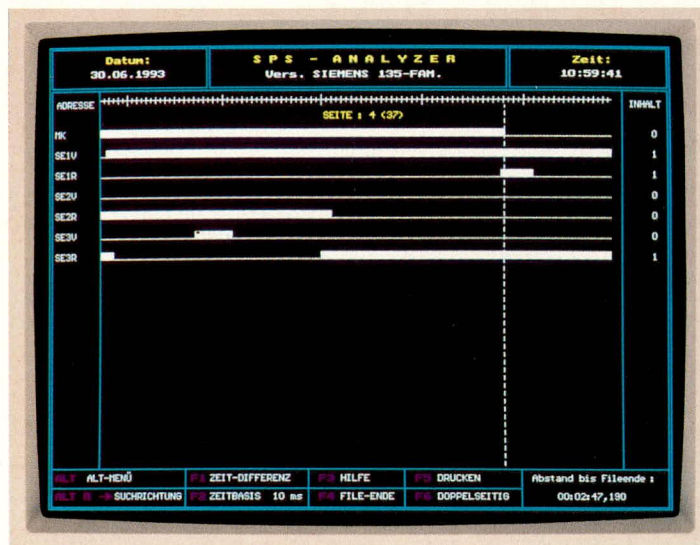
Bild 1: Durch Trigger MK erfaßte Endschalter-Überschneidung SE1V/SE1R
