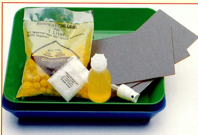
Bild 13 zeigt die Zusammenstellung von Materialien für die Eisen-III-Chlorid-Ätzung: Kunststoffschalen, Eisen-III-Chlorid im Beutel, Entwickler, Basismaterial, Lötlack.
