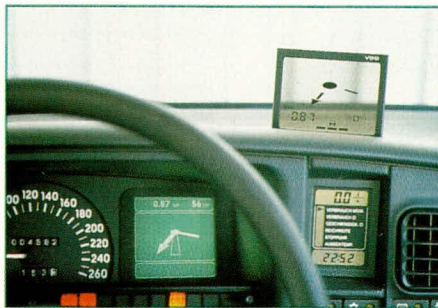
Bild 7: Projekte im Rahmen des Prometheus-Vorhabens sind die Systeme EURO-SCOUT und TRAVEL-PILOT, hier in einem OPEL-Versuchsfahrzeug. Das transparente Display fährt bei gewählter Zielführung automatisch aus der Armaturentafel heraus
