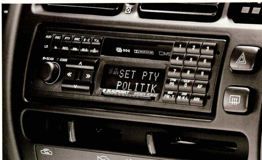
Bild 6: Die PTY-Funktion von RDS ermöglicht die gezielte Auswahl bestimmter Programmgenres (Bild: Blaupunkt)
