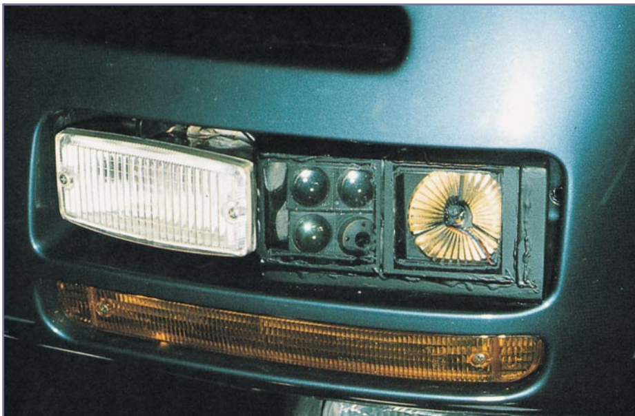
Bild 8: Die verschiedenen Sensoren zur Erfassung des Fahrbahnzustands in einem Prometheus-Versuchsfahrzeug.
