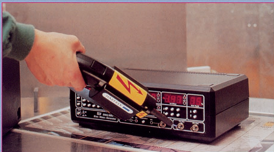
ESD-Prüfung eines Tischgerätes mit 8kV-Entladespannung bei Luftentladung
