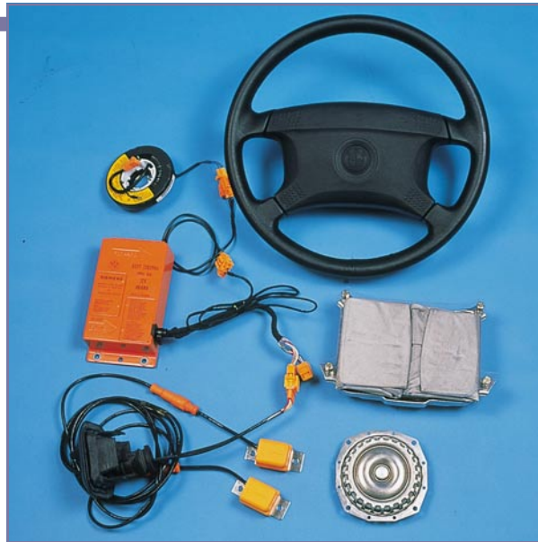
Bild 5: Komplette Airbag-Ausstattung. Unten im Bild die beiden Crash-Sensoren. (Foto: BMW)
