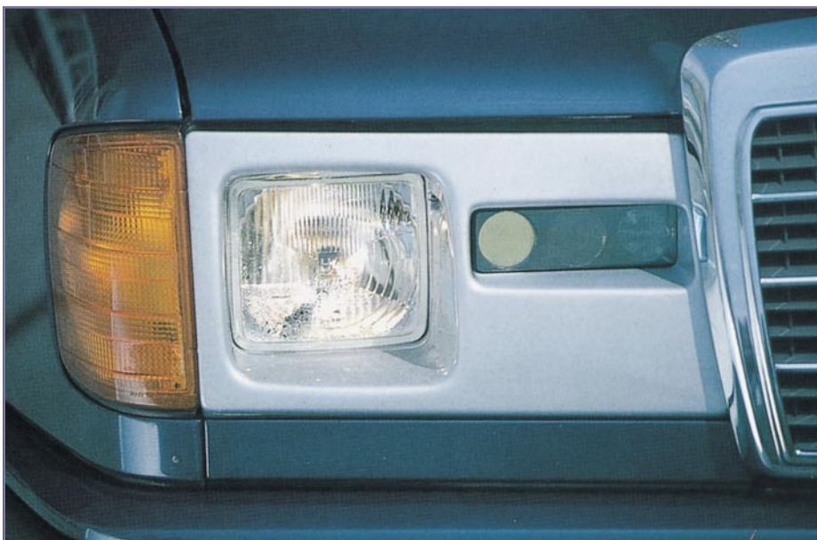
Bild 9: Abstandssensoren in einem Versuchsträger des Prometheus-Projekts.
