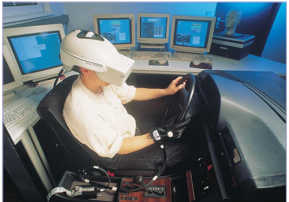
Bild 1: So sieht der Arbeitsplatz des Automobil designers und des Testers zukünftig aus: Datenhandschuh, Monitorhelm und ein Mehrprozessorsystem sind die wichtigsten Arbeitsinstrumente.
