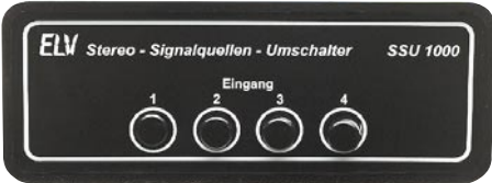
▲ Stereo-Signalquellen-Umschalter ohne aktive Komponenten. Seite 22
