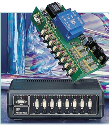
RS485-Hub ▲ Aktiver Sternkoppler für Netzwerkeinsatz. Seite 82
