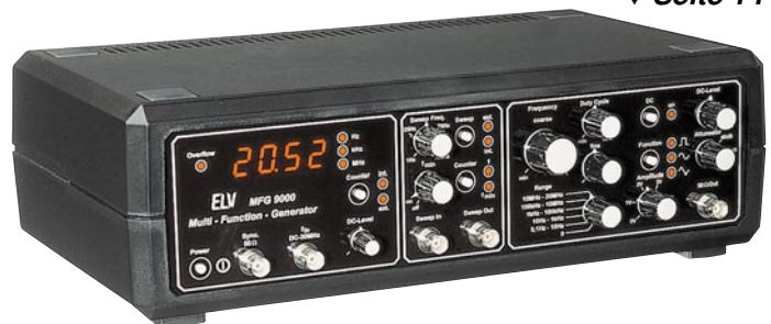
Multi-Funktions-Generator 20MHz-Funktions-Generator mit integriertem Frequenzzähler. ▼ Seite 14
