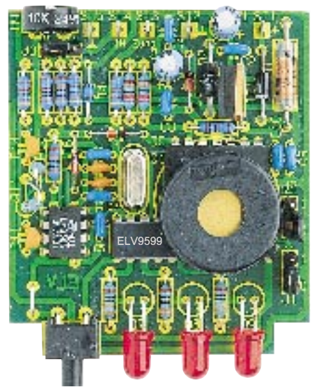
Bestückungsplan des Geschwindigkeitswarners GW 3
