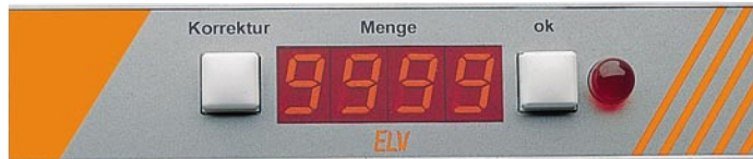
Bild 1: Displayeinheit zur Kennzeichnung des Lagerfaches und der Stückzahl
