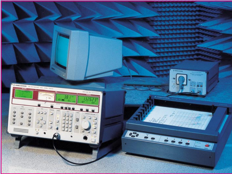
Bild 2: Aufbau für eine Funkstörspannungsmessung
