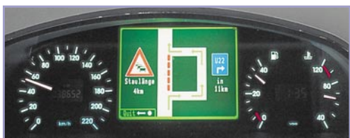
Bild 8: Eingebildet je nach Bedarf: Auf modernen Flachbildschirmeneinheiten erscheint jederzeit die gewünschte Information direkt im Blickfeld (Bild: VDO).
