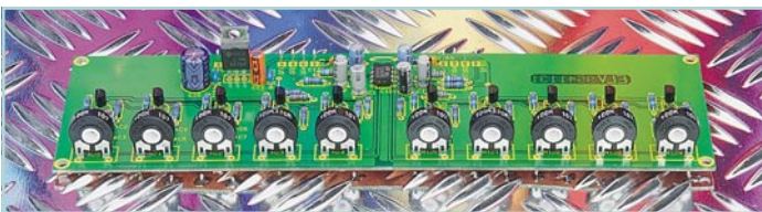
5-Kanal-Stereo-Equalizer ▲ Klanganpassung eines Audiosignals an individuelle Raumakustik. Seite 64
