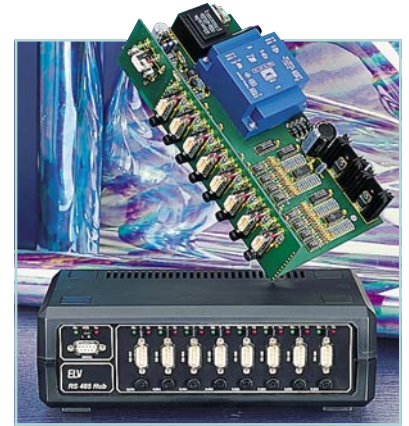
RS485-Hub ▲ Aktiver Sternkoppler für Netzwerkeinsatz. Seite 51
