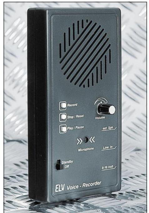
Der hier vorgestellte Single-Chip-Voice-Recorder erlaubt die analoge Speicherung von beliebigen Audio-Signalen bis max. 90 Sekunden in hervorragender Qualität, wobei die aufgezeichneten Informationen auch ohne Versorgungsspannung bis zu 100 Jahre (!) erhalten bleiben.
