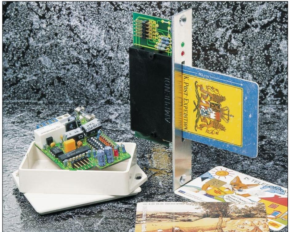
natürlich nur dann, wenn diese Karte eine Berechtigung besitzt. Hierzu liest der im Elektronikschloß arbeitende Mikroprozessor die entsprechenden Daten der Chipkarte aus und vergleicht sie mit den im eigenen Speicher abgelegten Daten, um dann bei einer Übereinstimmung die Freigabe zu erteilen. Da eine Karte in der Regel natürlich
