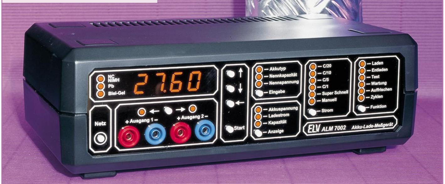
**Als Nachfolger des 1000fach bewährten ALM 7001 stellen wir Ihnen mit dem ALM 7002 eine konsequent weiterentwickelte Version vor, die mikroprozessorgesteuert nach neuester Ladetechnologie arbeitet. Das Gerät ist geeignet zum vollautomatischen Laden, Entladen, Testen, Warten und Auffrischen von NC-, NiMH- und Blei-Akkus.**
