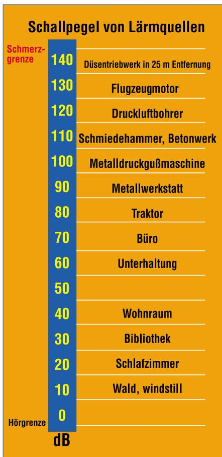
**Bild 1:** Die Skala der im Alltag vorkommenden Schallpegel (Quelle: Sennheiser)
