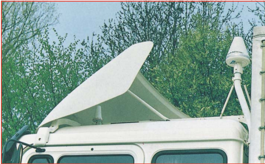
Bild 4: Kennzeichnet schon viele LKW größerer, europaweit agierender LKW-Flotten: Satellitenantennen (hier Eutelsat) auf dem LKW-Dach.
