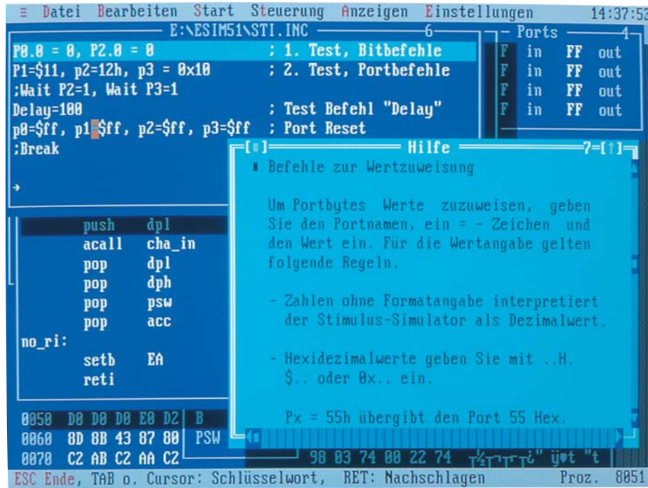
Bild 2: Aufbau einer Stimulus-Datei, die zeilenweise synchron zu den Mikrocontroller-Befehlen abgearbeitet wird.
