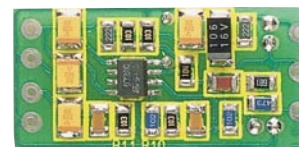
Ansicht der fertig bestückten Leiterplatte (Lötseite)
