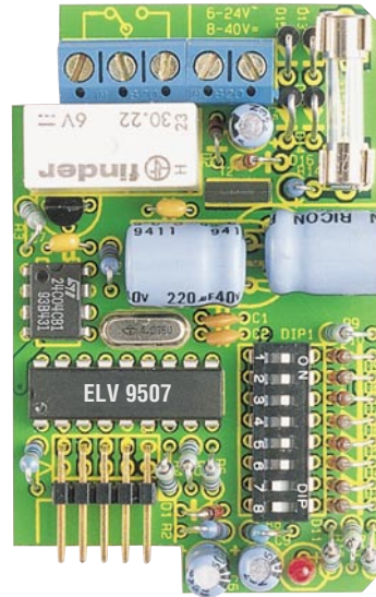
Fertig aufgebaute Kartenleserplatine mit zugehörigem Bestückungsplan
