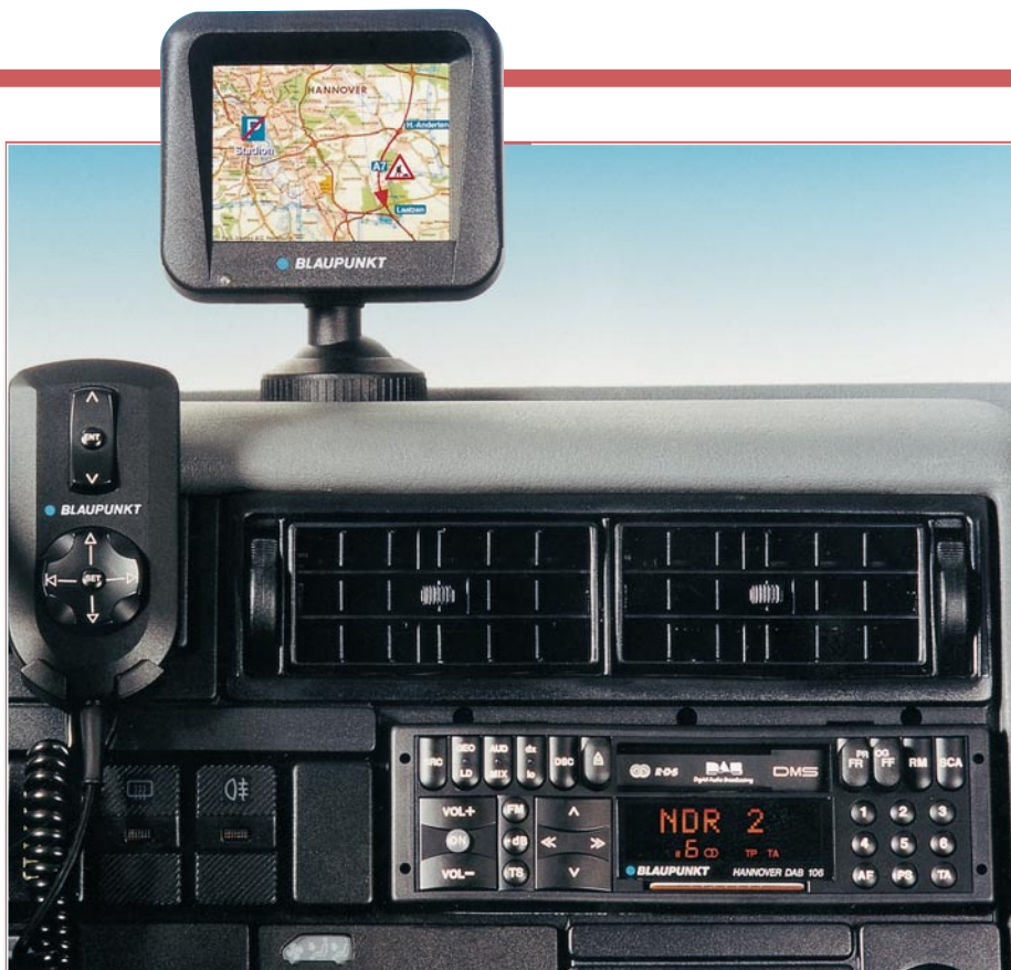
Bild 2: Komplette DAB-Anlage für das Auto mit Front-End, DAB-Empfänger und Datenbildschirm (Foto: Bosch-Blaupunkt).
