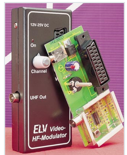
▲ Video-HF-Modulator Moduliert Bild- und Tonsignal auf einen HF-Träger. Seite 58
