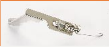
Bild 2: Die Zugfedern der 1,5V-Ladeschächte sind entsprechend dem Foto an die Minuskontakte anzulöten. Das Lötzinn darf nur innerhalb der Öse verlaufen.
