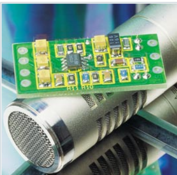
▲ SMD-Mikrofonvorverstärker Für alle Mikrofontypen geeignet. Seite 48
