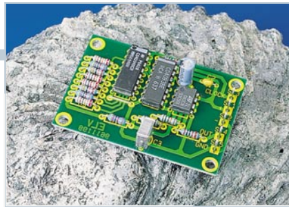
◀ Digital-Sinusgenerator Für Frequenzen bis 100 kHz. Seite 42
