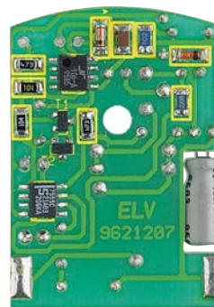
Ansicht der Bestückungs- und Leiterbahnseite des Handsenders
