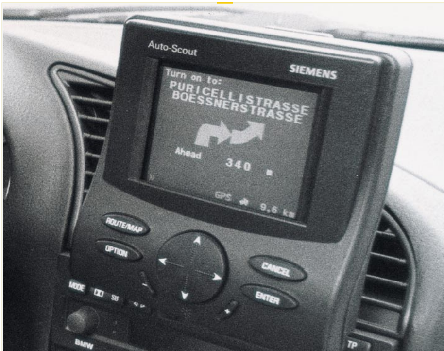
Bild 4: Das Auto-Scout-System ermöglicht die kostengünstige Navigationslösung unabhängig vom Fahrzeugtyp. Foto: Siemens
