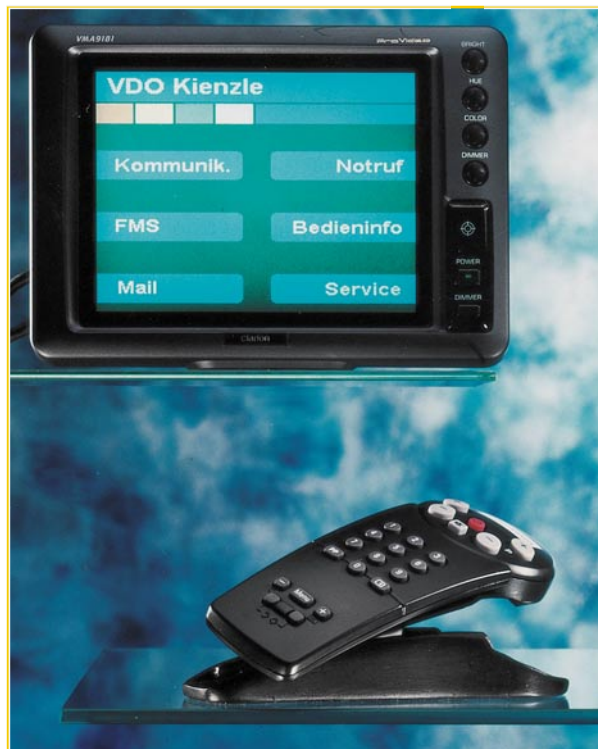
Bild 3: Auch als Nachrüstvariante bietet das VDO-Fahrerinformationssystem einen schnellen Überblick über alle Systeme und eine einfache Bedienung über eine Tastatur. Foto: VDO
