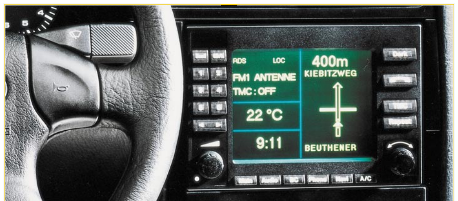
Bild 5: Die komplexe Integration verschiedener Kommunikations- und Bedienungskomponenten in einem zentralen und ergonomischen System erlaubt der Siemens-Vorschlag eines Fahrerinformationssystems. Foto: Siemens
