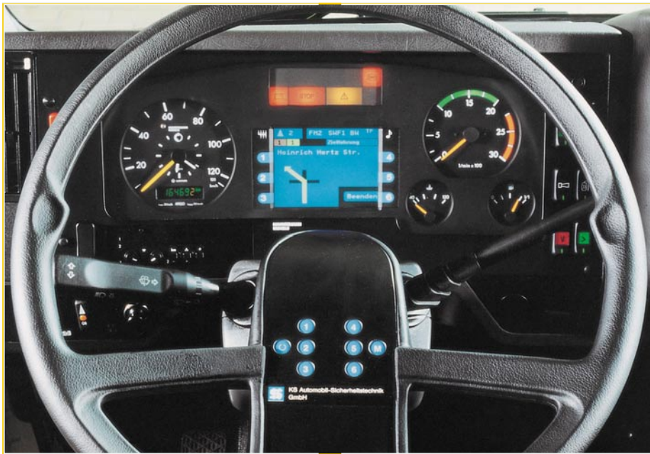
Bild 2: Komplexes Nutzfahrzeug-Fahrerinformationssystem zur ergonomischen Zusammenfassung aller Verkehrsleternetzinformationen. Foto: VDO
