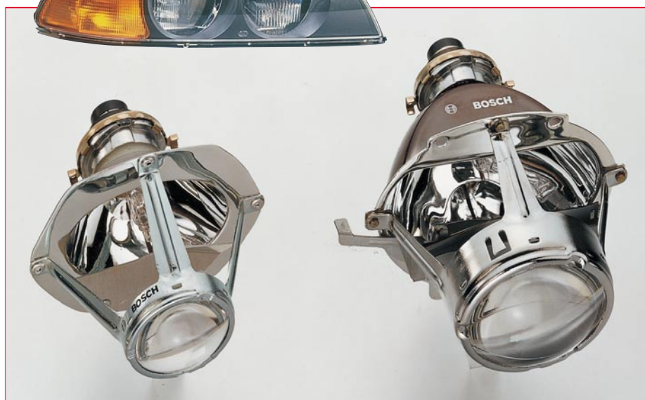
Bild 2: Die Mini-PES-Litronic-Scheinwerfer stellen eine extrem kompakte Generation der DE-Scheinwerfer dar. Links die noch einmal um die Hälfte kleinere Version des Xenon-Scheinwerfers. Foto: Bosch.
