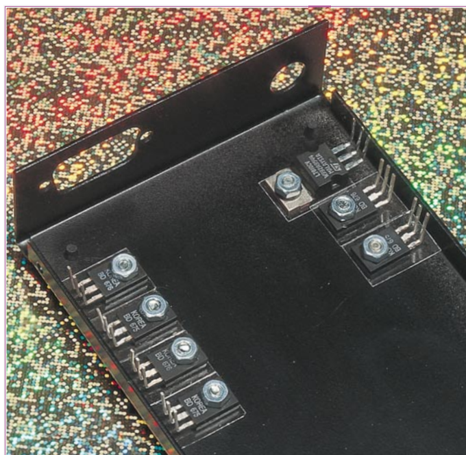
Bild 3: Ansicht des Gehäuseunterteils mit montierten Transistoren und Spannungsregler
