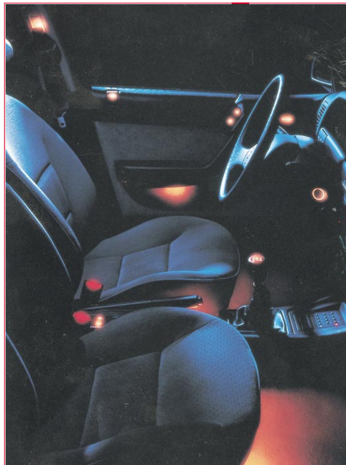
Bild 19: Die CELIS-Orientierungsbeleuchtung sieht bis zu 24 Beleuchtungsfunktionen im Innenraum vor. Durch die dezente Beleuchtung der Funktionselemente soll auch die Raumwahrnehmung im Fahrzeuginnenraum entscheidend verbessert werden. Foto: Hella
