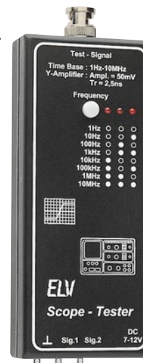
Scope-Tester ▶ Zur Überprüfung aller wesentlichen Oszilloskop- Parameter. Seite 64
