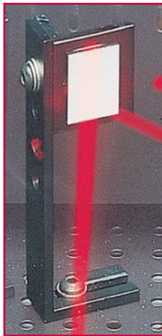
Bild 10: Spiegelhalter mit angeschraubtem Haltewinkel und aufgeklebtem Oberflächenspiegel
