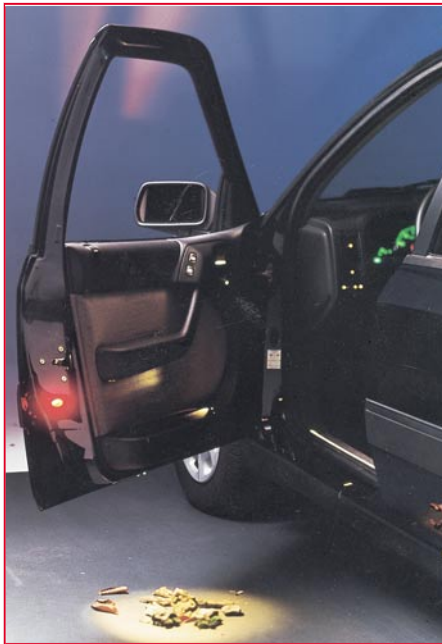
Bild 17: Sicheres Ein- und Aussteigen mit dem „Pfützenlicht“ und der Türwarnleuchte. Neben diesen werden beim Öffnen der Tür Türschwelle, Zündschloß, Sitz- und Gurtverstellung durch das CELIS-System beleuchtet. Foto: Hella
