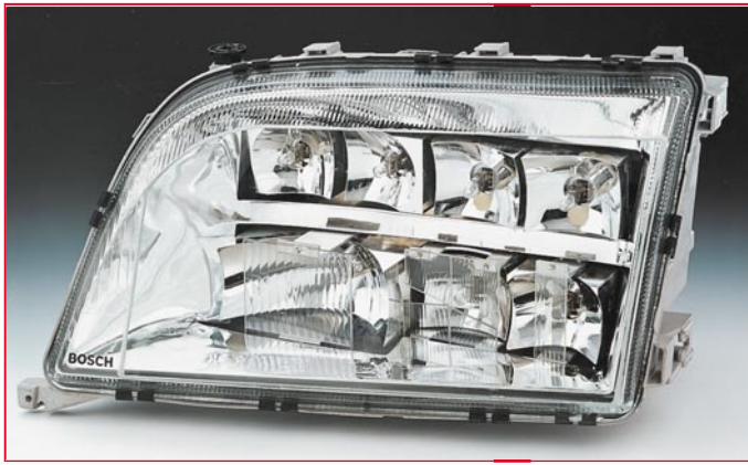
Bild 11: Der Scheinwerfer mit variabler Lichtverteilung besteht aus einer Vielzahl speziell ausgelegter Einzelreflektoren, die durch die Fahrzeugelektronik intelligent gesteuert werden. Foto: Bosch.
