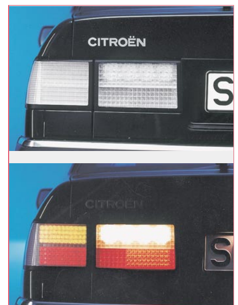
Bild 13: Ein markantes Heckprofil durch weiße Optik verleiht die LED-Heckleuchtenstudie dem Prototypenfahrzeug. Rote und gelbe LEDs erzeugen die Farben, der Rückfahrcheinwerfer wird durch eine Kleinglühlampenkombination gebildet. Foto: Hella.
