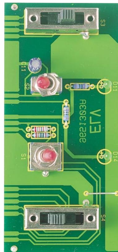
Ansicht der fertig bestückten Frontplatte
