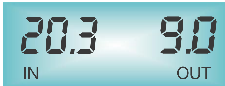
Bild 2: Anzeige im normalen Betrieb. Links Innentemperatur, rechts Außentemperatur
