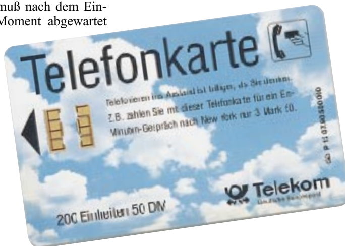
Bild 3: Ein Telefonkartenchip der ersten Generation. Deutlich erkennt man die ISO-Anschlußstruktur und die vorwiegende Ausführung als Speicher (gleichmäßige Chipstruktur)
