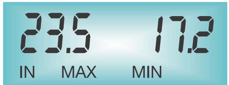
Bild 3: Anzeige der MIN/MAX-Werte, hier für die Innentemperatur
