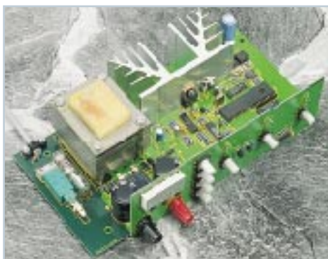
▲ Akku-Lade-Meßgerät ALM 7003 zum vollautomatischen Laden, Entladen, Testen und Regenerieren (Zyklen) von Ni- und NiMH-Akkus und Akkupacks Seite 46
