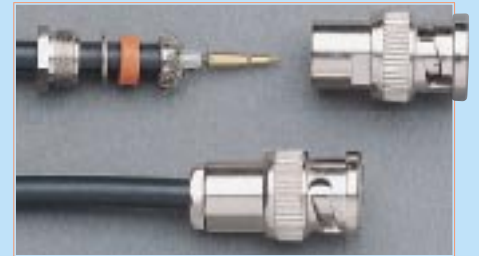
Bild 13: Montierter und teilmontierter BNC-Stecker in Schraubtechnik.
