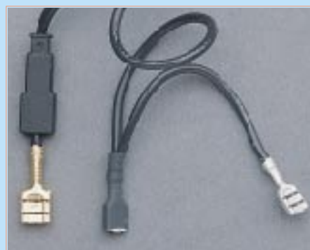
Bild 20: Gecrimpte Kfz-Flachstecker, z. T. mit Schrumpfschlauch isoliert.
