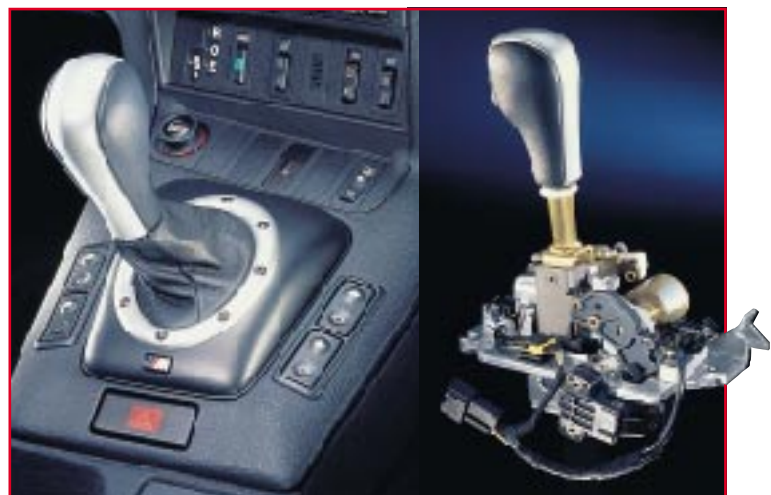
Bild 4: Der Schalthebel des sequentiellen M-Getriebes von BMW, rechts sind deutlich die Schaltelemente zu sehen. (Foto: BMW)
