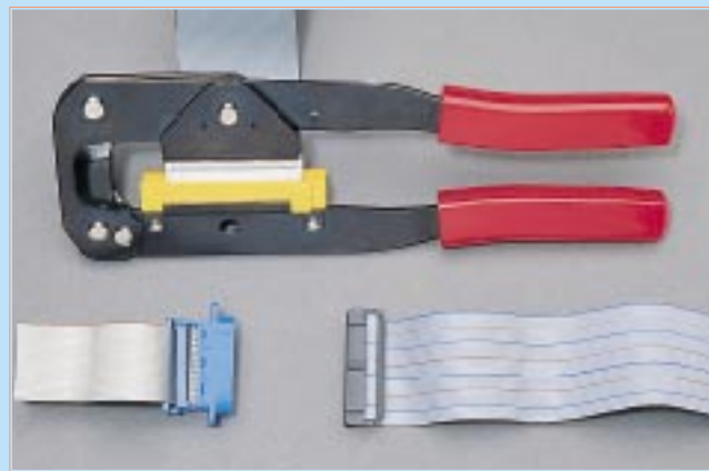
Bild 18: Die Montage in Schneidklemmtechnik sollte mit einer speziellen Crimpzange erfolgen. Im Bild Crimpzange mit eingelegtem Steckverbinder, vormontierter Steckverbinder und Muster mit Zugentlastung
