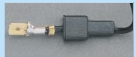
Bild 21: Es geht auch ohne Crimpzange: gelóteteter Kfz-Flachstecker
