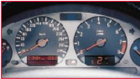
Bild 5: Wie in der Formel 1: Das Digitaldisplay im Drehzahlmesser zeigt den Schaltzustand an und gibt Schalterempfehlungen an den Fahrer. (Foto: BMW)
