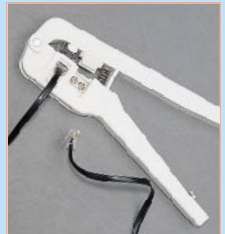
Bild 15: Montierter Western-Modularstecker und Crimpzange in Aktion
