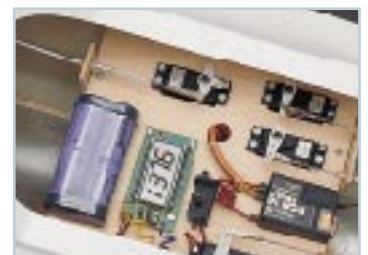
▲ Stromverbrauchsanzeige für Modellbau zeigt die aus einem Akku entnommene Energie auf einem 4stelligen LC-Display an Seite 13
