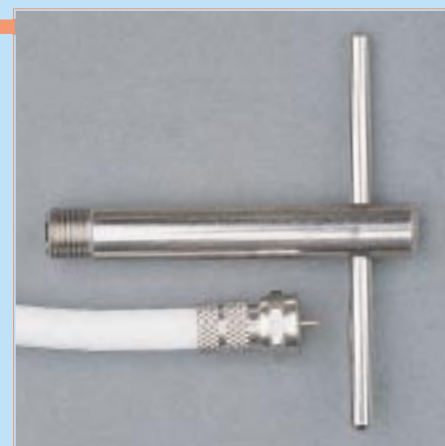
Bild 5: Montagebeispiel F-Aufdrehstecker mit Montagehilfe
