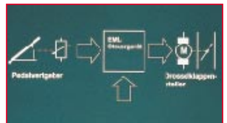
Bild 3: Die Grundkomponenten der elektronischen Motorregelung mit elektronischem Gaspedal, Motorsteuerung und Drosselklappenverstellung. (Foto: BMW)
