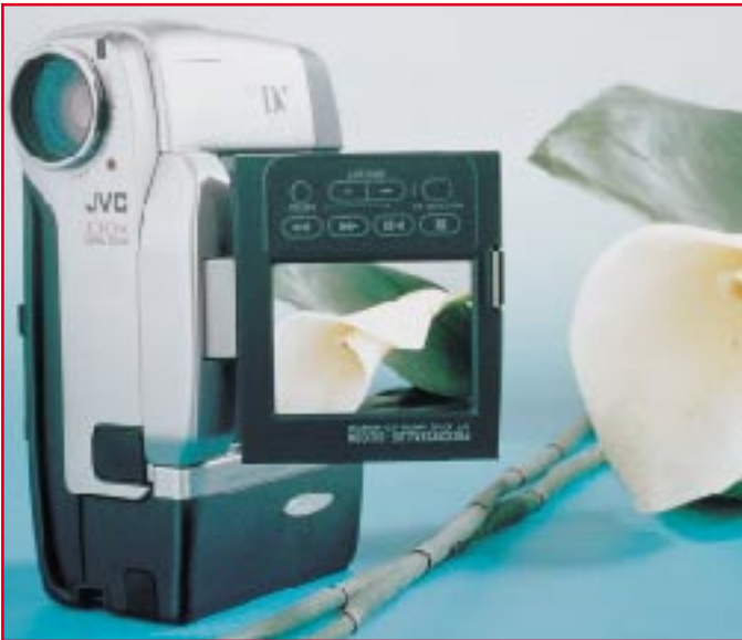
Bild 3: Die zweite Generation der digitalen Pocket-Camcorder mit superscharf (180.000 Pixel) abbildendem 6cm-LCD-Monitor in TFT-Technik. Die zugehörige Heimstation enthält eine integrierte Capturekarte für die direkte Bildausgabe auf einen PC. Mit der zugehörigen Software lassen sich Bildarchive anlegen und umfangreiche Schnittfunktionen ausführen. Foto: JVC
