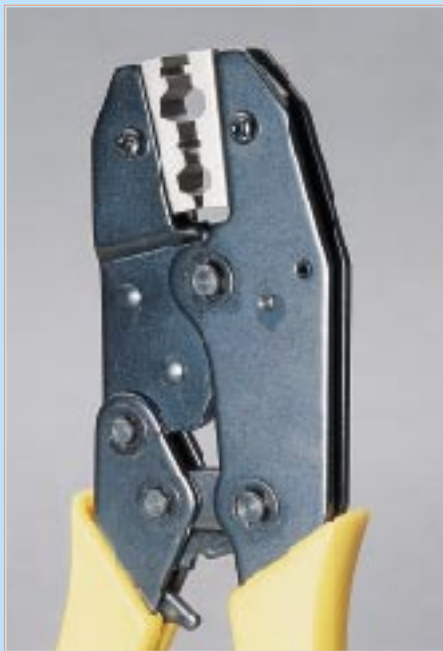
Bild 1: Professionelle Crimpzange mit Backeneinsatz für RG 58-Kabel. Auswechselbare Einsätze ermöglichen auch das Crimpen bzw. Quetschen von isolierten und unisolierten Kabelschuhen und Steckverbindern.
