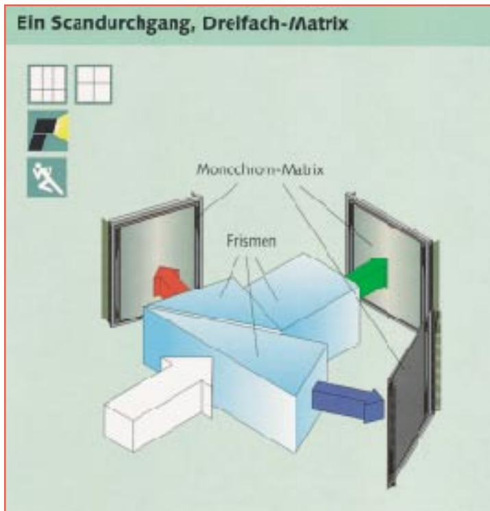
Bild 4: Eine ausgeklügelte Prismenanordnung sorgt im statischen CCD-System für die Aufteilung des Lichtspektrums in die drei Grundfarben und die entsprechende Belichtung von drei CCD-Matrixanordnungen. Grafik: Agfa
