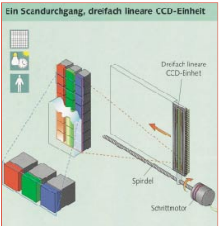
Bild 3 (unten): So arbeitet ein Zeilen-CCD-Scanner. Ein Schrittmotor bewegt die drei CCD-Zeilen exakt über die Bildaufnahme- fläche. Grafik: Agfa
