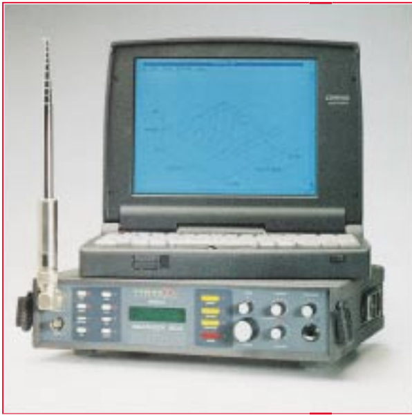
Bild 3: Professionelles Werkzeug für das Wanzen-„Sweeping“ - der Cerberus-Nahfeldempfänger mit zugehöriger Computer-Auswertesoftware (Foto: Fink Security Consulting)
