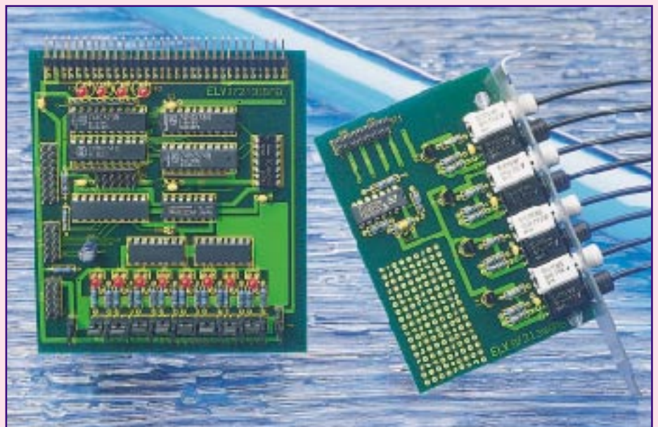
Bild 2: Digitale Ein-/Ausgabe-baugruppe für die ELV-DSP50-Karte mit jeweils 4 optischen Sendern und 4 optischen Empfängern
