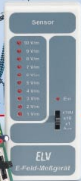
E-Feld-Meßgerät Erfassung elektrischer Wechselfelder von 1 V/m - 1000 V/m
