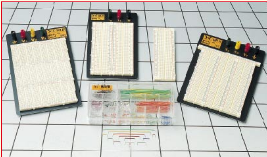
Bild 1: Grundlage unserer praktischen Experimente zur Digitaltechnik - ein Experimentierboard mit den zugehörigen, konfektionierten Drahtbrücken - Löten also überflüssig.
