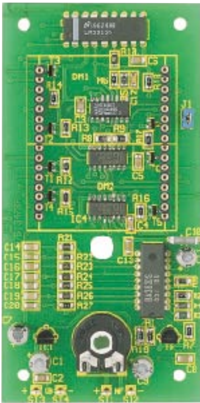
Fertig aufgebaute Platine mit zugehörigem Bestückungsplan des NF-Spektrum-Analyzers
