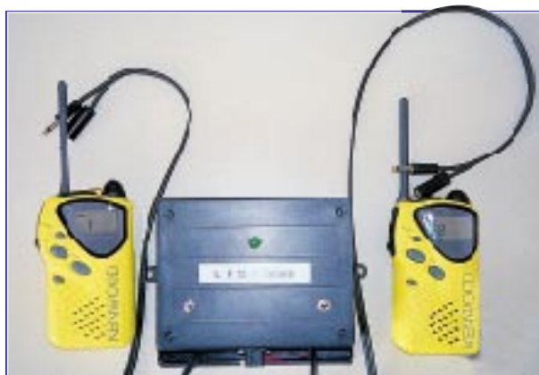
Bild 11: Erweitert den Aktionsbereich der LPD-Handys auf bis zu 40 Kilometer - die LPD-Relaisstation. Foto: com-com
