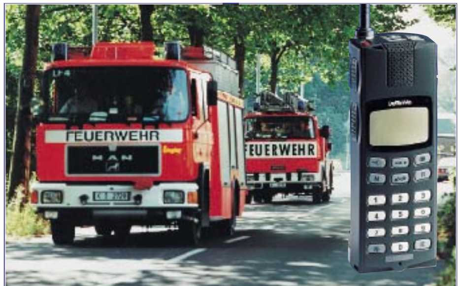
Bild 2: Der kommerzielle Betriebsfunk arbeitet mit hochwertiger und robuster Funktechnik ebenfalls z. B. im 2 m- und 70 cm-Band. Foto: DeTeWe/GfD
