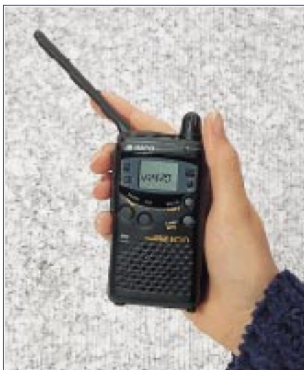
Bild 3: Durch die einklappbare Antenne noch kompakter und mit äußerst professioneller Ausstattung wie z. B. 138 Kanälen durch 12,5 kHz-Raster, S-Meter, CTCSS, Tonruf, 20 Speichern auch eines der leistungsfähigsten LPD-Geräte - das Alinco EC 10.
