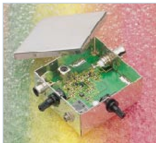
▲ 30V/5A-Labor-Schaltnetzteil mit hohem Wirkungsgrad und geringer Verlustleistung Seite 24
