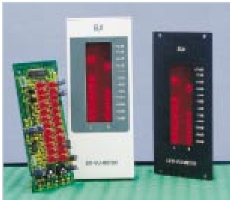
VU-Meter ▶ mit Peak-Hold Leuchtbandsanzeige mit 2 x 12 LEDs und Peak-Hold-Funktion Seite 39
