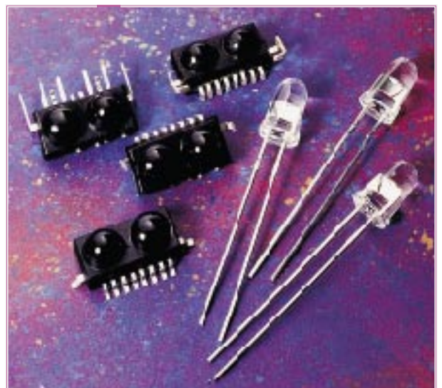
Bild 12: Deutlicher Unterschied - rechts die großen und leistungsfähigen IR-Sendedioden der üblichen Bauform, wie sie auch als Zusatz-Sendedioden Anwendung finden, links die kompakten, vergossenen und eingeschwärzten IrDA-Module mit Sender, Empfänger und integrierter Elektronik.
