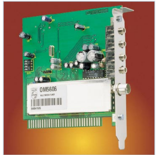
ELV-PC- ▶ Multimedia-Radio mit Philips UM 5604-Multimedia-FM-Tuner, R(B)DS-Decoder, 5-Band-Equalizer und 2 x 6W-HiFi-Verstärker Seite 79
