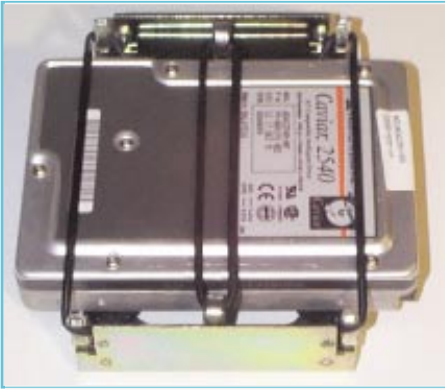
Bild 6: So in einen Spezialrahmen zwischen zwei stabilen Gummibändern eingespannt, werden erfolgreich tieffrequente Schwingungen der Festplatte eliminiert. Ergänzt wird das System bei Bedarf durch einen ebenfalls schwingungsfrei montierten leisen Lüfter.
