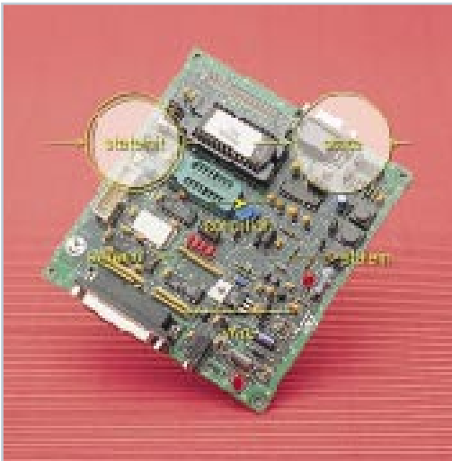
VU-Meter ▶ mit Peak-Hold Leuchtbandsanzeige mit 2 x 12 LEDs und Peak-Hold-Funktion Seite 39
