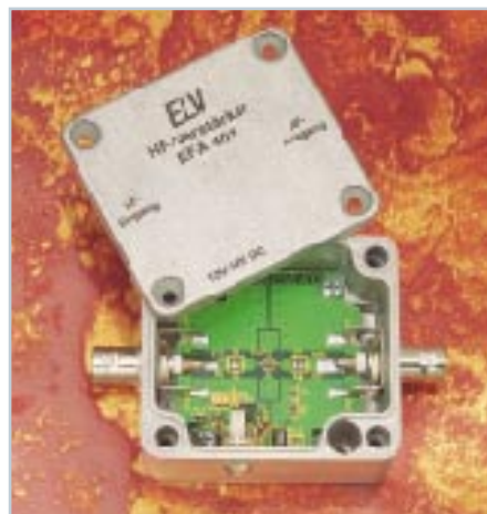
HF-Verstärker ▶ RFA 401 Für den weiten Frequenzbereich von 10 MHz bis 1,3 GHz Seite 46
