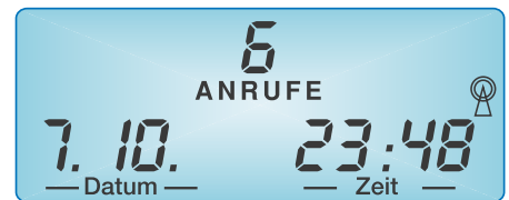
Bild 8: Die Anzahl der eingegangenen Anrufe während der Abwesenheit wird übersichtlich im Display angezeigt. Jeder Anruf ist einzeln abfragbar.
