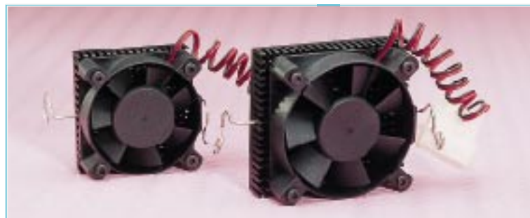
Bild 3: Der Austausch von lauten CPU-Lüftern gegen leise Exemplare bringt Ruhe an der CPU - im Bild zwei besonders leise Exemplare von „A Conto“, links für Pentium, rechts für Pentium Pro.
