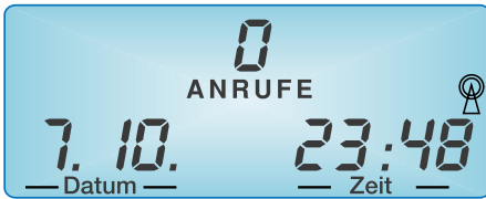
Bild 5: Displayansicht nach dem Einschalten des CallBoy und erfolgreicher Synchronisierung mit dem DCF-77-Zeitzeichensender.
