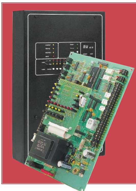
Bild 8: Eine Alarmzentrale ermöglicht die intelligente Weiterverarbeitung einer Vielzahl von Alarmmeldungen.
