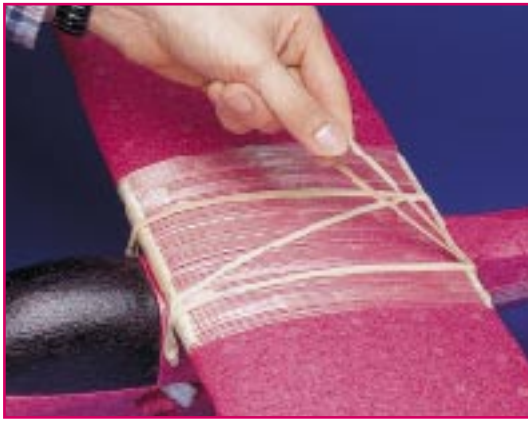
Spatz-typisch auch die Tragflächenmontage: mit Klebeband geklebt und verstärkt, mit straffen Gummiringen am Rumpf befestigt.
