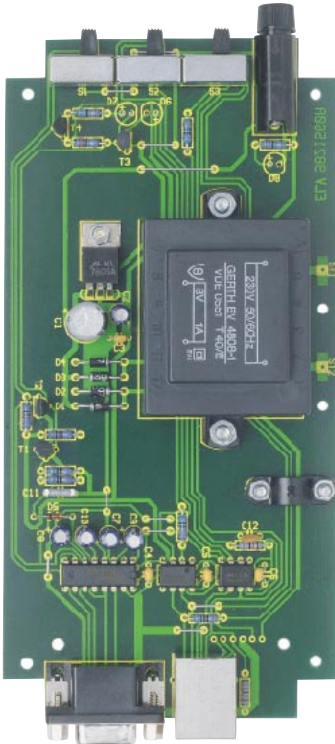
Ansicht der fertig bestückten Platine des RS232 nach RS485/422-Wandlers mit zugehörigem Bestückungsplan
