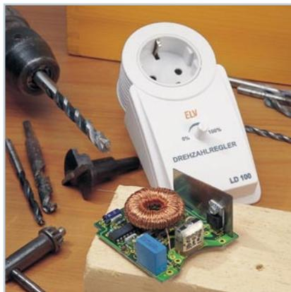
◀ **Drehzahlregler für Elektrowerkzeuge** zur Einstellung und lastunabhängigen automatischen Drehzahlregelung
