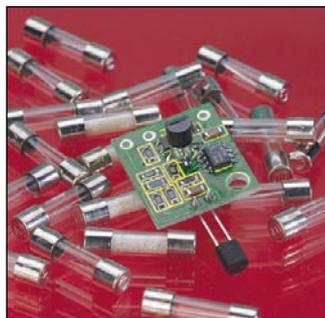
Die Temperatursicherung ermöglicht bei äußerst geringem Platzbedarf, der einen einfachen Einbau auch in vorhandene Geräte erlaubt, die Überwachung und ggf. Abschaltung (Ansprechtemperatur
