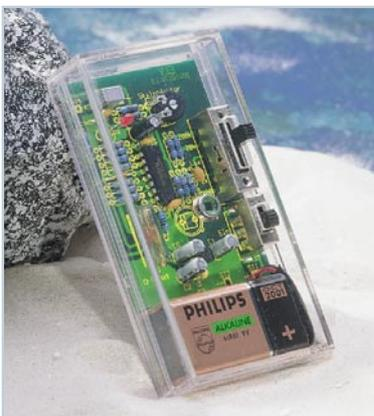
◀ **Luxmetervorsatz für Multimeter**
