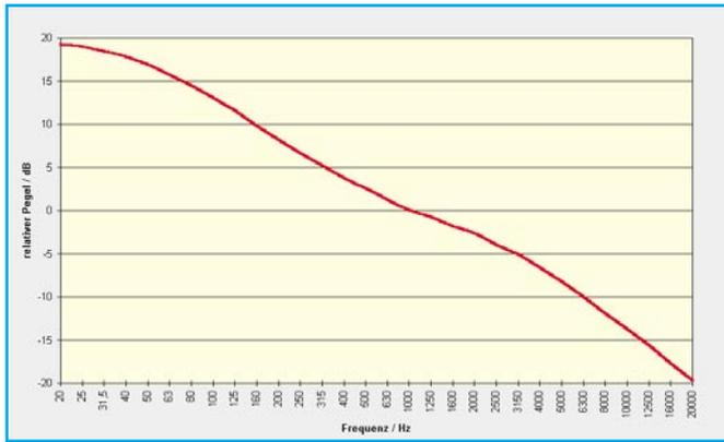
**Abbildung 55: Frequenzgang eines Phonozenterrungsverstärkers nach RIAA**
