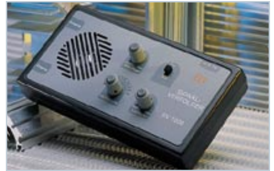
▲ Signalverfolger SV 1000 zur schnellen Fehlersuche in Audiogeräten Seite 64
