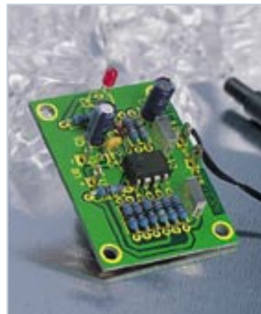
▼ Frostwarner Einfache, zuverlässige Schaltung zur Temperaturüberwachung Seite 62
