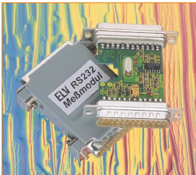
Bild 11: PMess4Win arbeitet komfortabel mit dem ELV-PC-Meßmodul M 232 zusammen.
