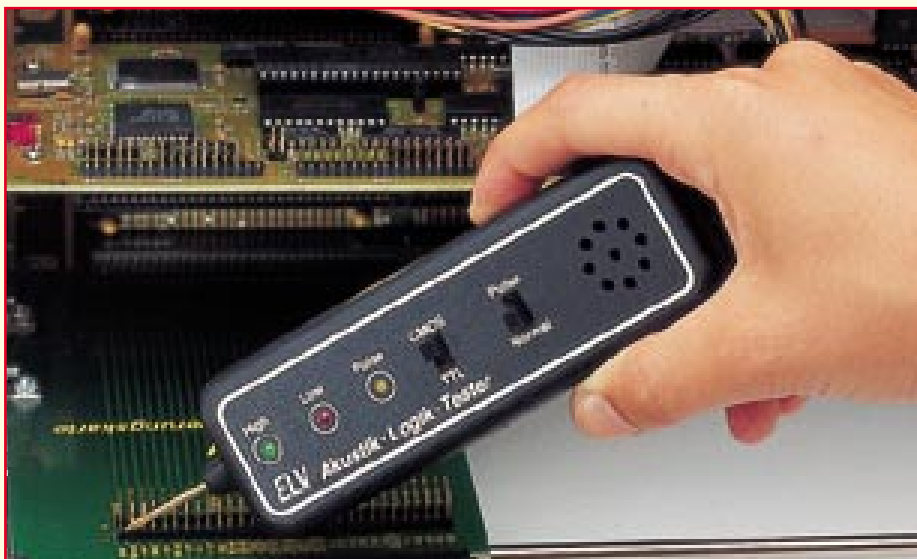
Bild 60: Unentbehrliches Testgerät - Logikpegeltester ALT 3
