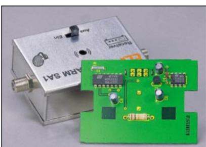
In das Satelliten-Antennenkabel geschaltet, registriert der SA 1 das Trennen des Kabels, z. B. wenn der LNB demontiert wird und warnt durch einen integrierten Signalgeber mit einem lauten Alarmton. Das Gerät erfordert keine eigene Spannungsversorgung, es wird aus der LNB-Versorgung des Sat-Receiver gespeist und ist daher wartungsfrei.
