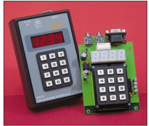
Damit sind über den einfachen Austausch von ASCII-Daten bzw. 7-Segment-Strings zahlreiche Anwendungen ohne spezielle Datenformate steuerbar. Zur Kommunikation mit dem Interface bieten sich Terminalprogramme oder einfache TP- bzw. BASIC-Routinen an. So kann das Interface z. B. als komfortables elektronisches Schloß genutzt werden.
