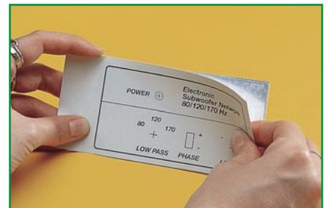
**Bild 7: So erfolgt das Aufkleben eines Papierausdrucks auf die Frontplatte mit Doppelklebefolie.**
