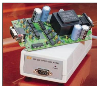
Stromversorgung. Eine Bedienung des Gerätes ist nicht erforderlich. Auch im Laborbetrieb ist ein solches Interface sehr nützlich und vor allem schnell und bequem einsetzbar, um störende Rückwirkungen zwischen PC und z. B. Meß-Peripherie zu vermeiden.
