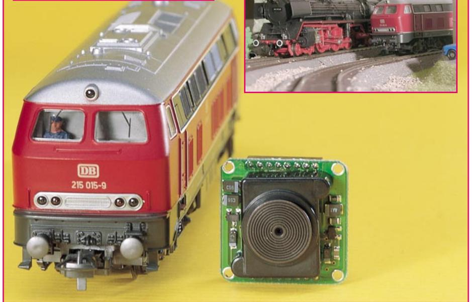
**Bild 18:** Faszination Lokführerstand - Mini-Kameramodule machen die „Mit-fahrt“ selbst in HO möglich.
