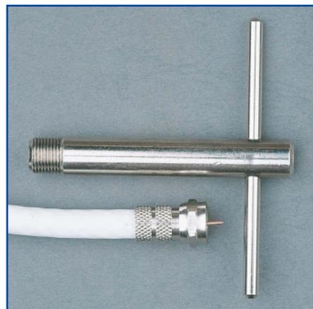
**Bild 20: Eine Montagehilfe sorgt für saubere F-Stecker-Montage.**
