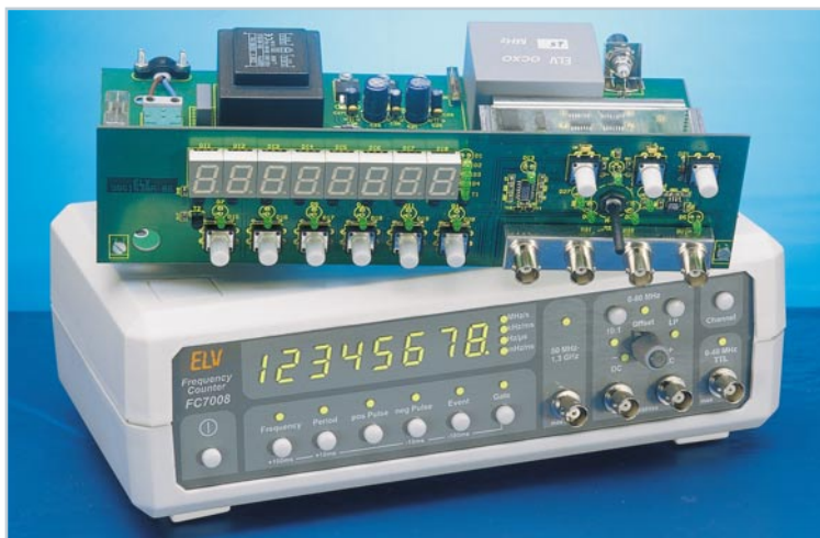
▲ Universal-Frequenzzähler FC 7007/7008 Mikroprozessor-Frequenzzähler bis 1,3 GHz - Nachbau und Abgleich
