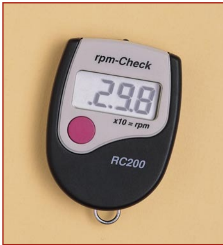
Bild 6: Dank der integrierten Hold-Funktion (Meßwertspeicherung im Display) sind auch Messungen an schwer zugänglichen Stellen möglich. Die drei Punkte zeigen die aktivierte Speicherung an.
