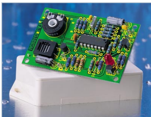
▲ 5-Kanal-HF-Schalt-signal-übertragung mit Sicherheitscode Übertragung von bis zu 5 codierten Schalt-signalen bei einer Reichweite von max. 100 m Seite 58
