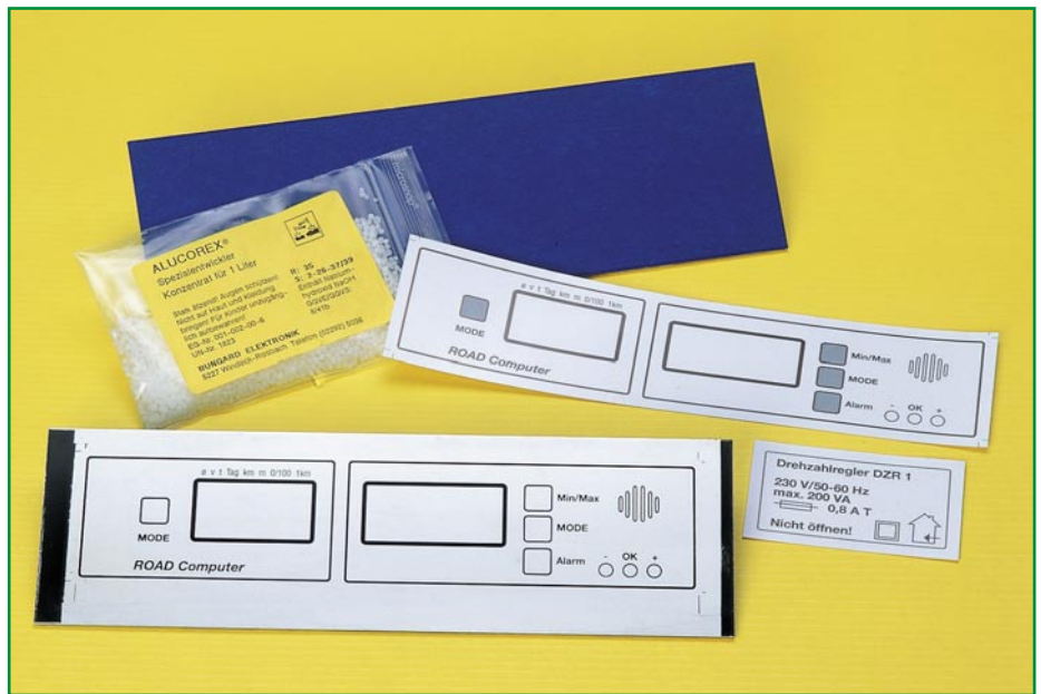
Bild 12: Höhepunkt des Frontplatten-Eigenbaus: Mit Fotopositiv-Lack beschichtete Alucorex-Frontplatte.
