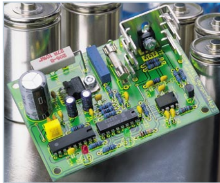
▲ rpm-Check Optoelektronisch abtastender Universal-Drehzahlmesser Seite 36
