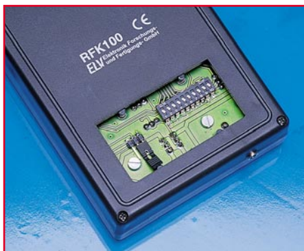
Bild 1: Die zur einmaligen Konfigurierung vorgesehenen Bedienelemente befinden sich hinter einer rückseitigen Gehäuseabdeckung.
