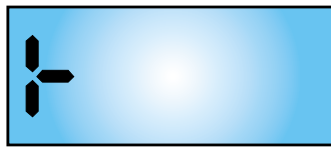
Bild 5: Messung gestartet, indem Kontakt 1 durchfahren wurde
