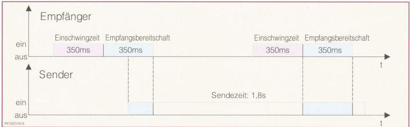
Bild 7: Sendesignal und Empfängereinschaltzeit
