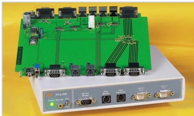
**▲ Monitor-, Tastatur- und Maus-Umschalter PCS 200** Betrieb von 2 PCs an einem Monitor, einer Maus und einer Tastatur
