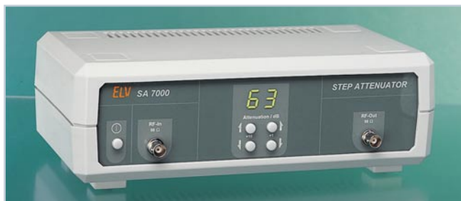
▲ HF-Dämpfungsglied SA 7000 für die definierte Einstellung von Dämpfungswerten zwischen 0 und 63 dB in 1dB-Schritten. Einsetzbar von DC bis 1 GHz Seite 29
