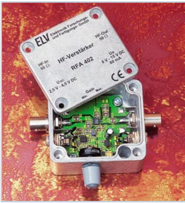
▲ 1,5 GHz - Regelbarer HF-Verstärker RFA 402 in 50Ω-Technik und mit hoher Verstärkung bis 28 dB Seite 76
