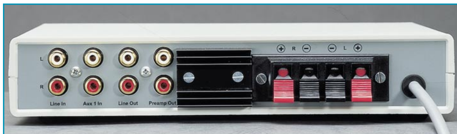
Bild 2: Die Rückseite des Verstärkers mit den Cinchbuchsen für NF-Ein- und Ausgänge und den Klemm-Lautsprecherterminals. In der Mitte ist der Kühlkörper für den Endstufenschaltkreis zu sehen.
