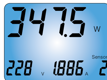
Bild 1: Anzeige der Wirkleistung, Netzspannung und Stromaufnahme.
