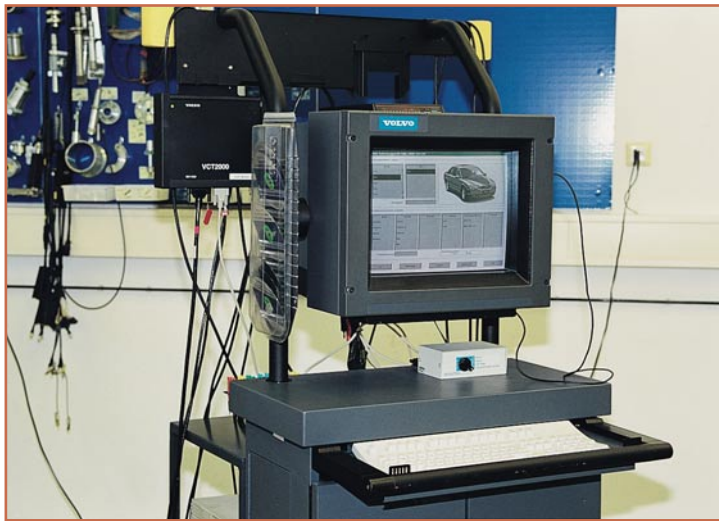
Bild 3: Einfachste Bedienung per Touch-Screen-Bildschirm - jeder Volvo-Händler ist mit diesem Equipment in der Lage, die neueste verfügbare Software aus der zentralen Datenbank abzufragen. Foto: Volvo
