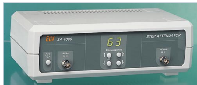
▲ HF-Dämpfungsglied SA 7000 für die definierte Einstellung von Dämpfungswerten zwischen 0 und 63 dB in 1dB-Schritten. Einsetzbar von DC bis 1 GHz.
