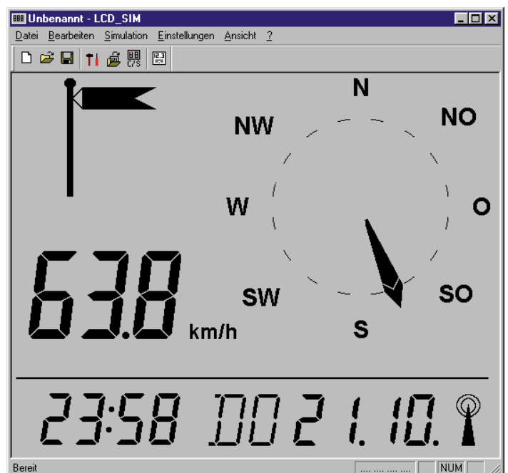
Bild 14: Im Simulatorlauf verhält sich das simulierte Display genau wie das spätere reale Display.
