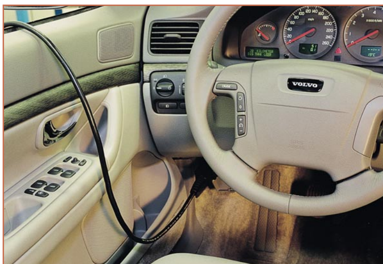
Bild 1: Über die Schnittstelle des On Board Diagnose Systems können sämtliche relevante Daten ausgelesen und neue Software ins Fahrzeug geladen werden. Foto: Volvo
