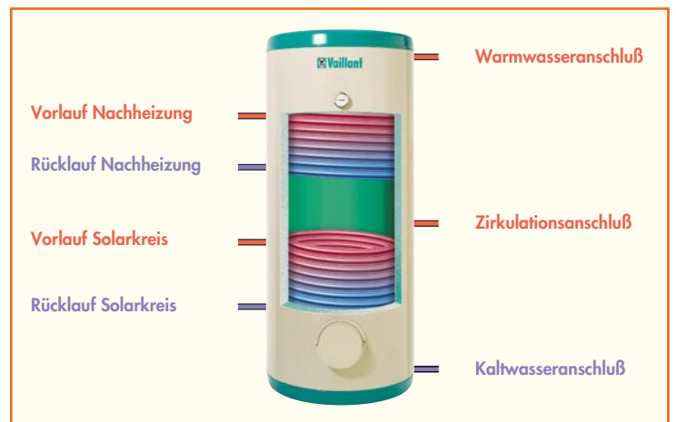
Bild 3: Schnitt durch einen Solarspeicher. Grafik: Vaillant
