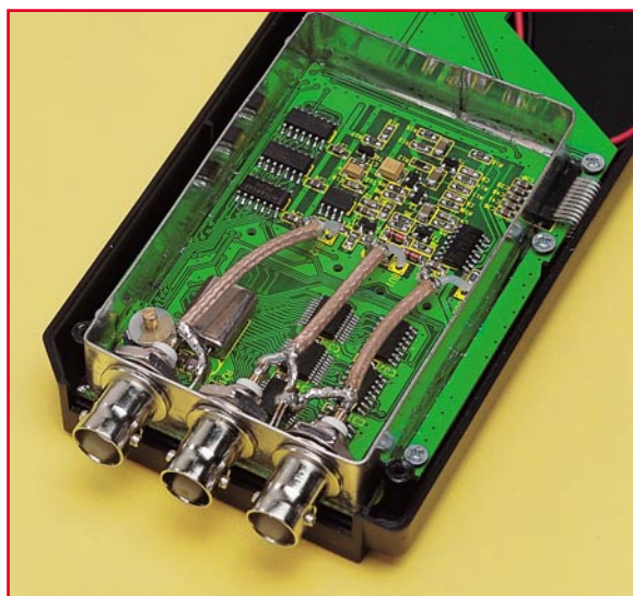
Bild 1: Innenansicht des Hand-Held-Frequenzzählers FC 500 mit angeschlossenen BNC-Buchsen
