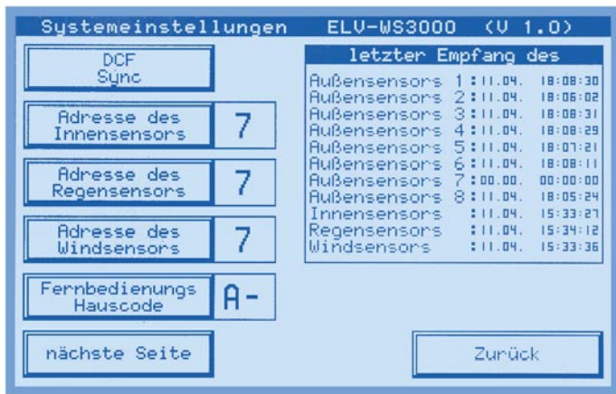
Bild 10: Die Systemeinstellungen: Hier sind wichtige Grundeinstellungen ebenso möglich wie eine manuelle Initialisierung von Funkuhr und Gesamtsystem, aber auch der Überblick über Sensorausfälle.
