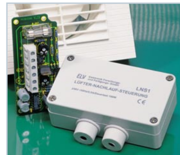
▲ Lüfter-Nachlaufsteuerung Schaltet netzbetriebene Lüfter verzö- gert ein und verzögert ab. Seite 32
