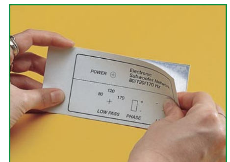
Bild 21: So erfolgt das Aufkleben der Frontplattenfolie
