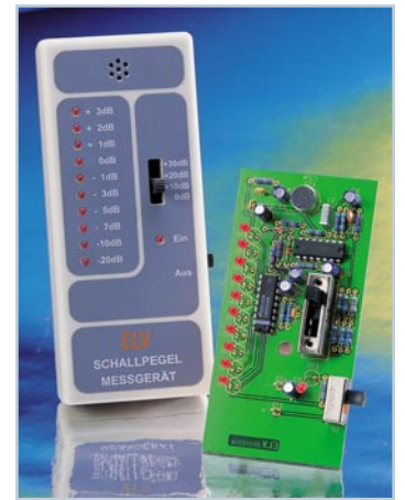
Mini- ▶ Schallpegelmessgerät für die Anzeige des relativen Schallpegels Seite 63
