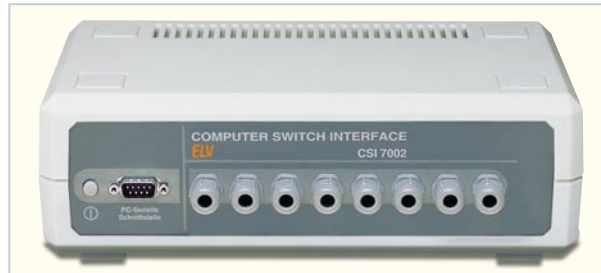
CSI 7002 ▶ 8-Kanal E/A-Inter- face für die serielle PC-Schnittstelle, Eingangsschaltspan- nung bis 230 V, Last- ausgänge bis 16 A Seite 10
