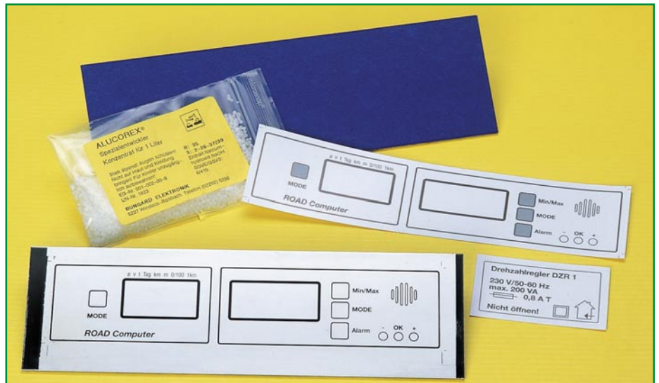
Bild 4: Hochqualitativer Frontplattenbau mit fotopositiv beschichteter Alucorex-Frontplatte
