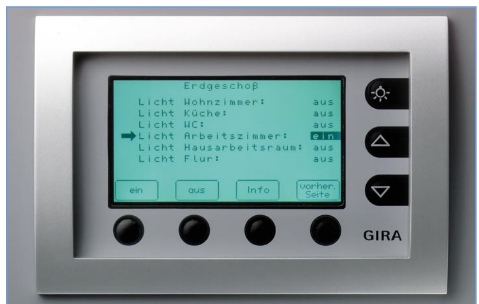
Bild 2: Der EIB wird dezentral gesteuert, eine Zusammenfassung von Informationen und Bedienelementen kann z. B. durch ein solches Terminal erfolgen. Bild: Gira Giersiepen GmbH
